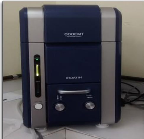
Figura 18: Microscópio Eletrônico de Varredura (MEV) de bancada.
