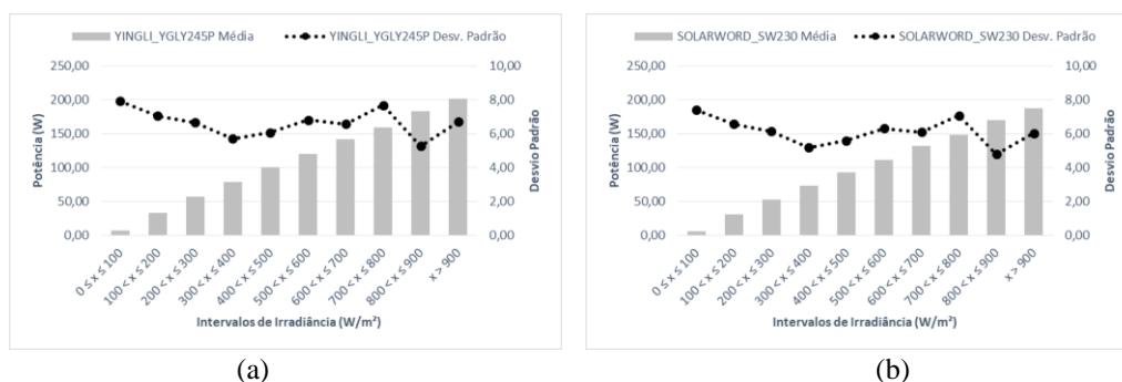
Figura 4.5 – Evolução das variabilidades observadas do modelo do coeficiente de temperatura (M1) durante as estimativas de desempenho: (a) YGLY245P; (b) SW230; (c) KD250GH-4FB2; (d) 60MCI.
