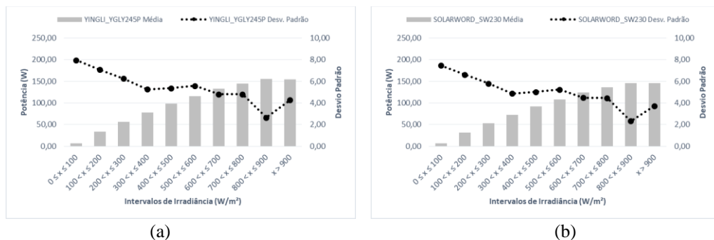
Figura 4.11 – Evolução das variabilidades observadas modelo simplificado (M7) durante as estimativas de desempenho: (a) YGLY245P; (b) SW230; (c) KD250GH-4FB2; (d) 60MCI.
