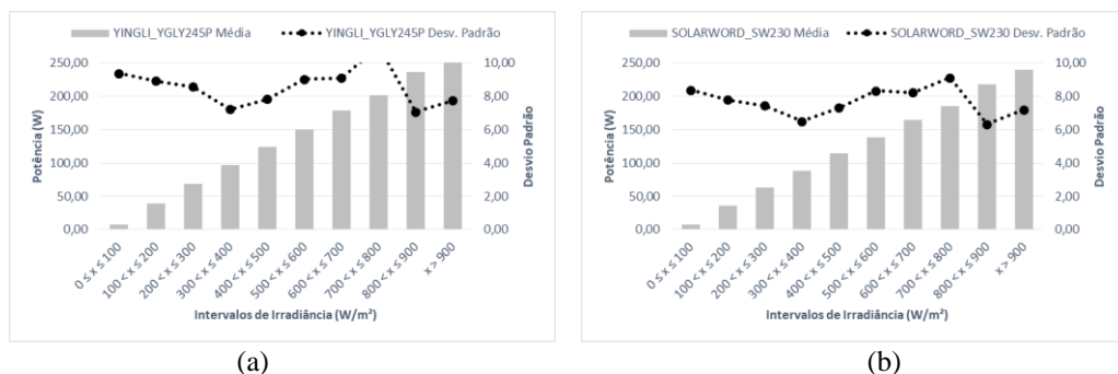
Figura 4.15 – Evolução das variabilidades observadas modelo do circuito equivalente ideal (M11) durante as estimativas de desempenho: (a) YGLY245P; (b) SW230; (c) KD250GH-4FB2; (d) 60MCI.
