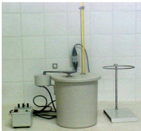
**Figura 17 – Fotografia da bomba calorimétrica usada para determinação do poder calorífico.**
