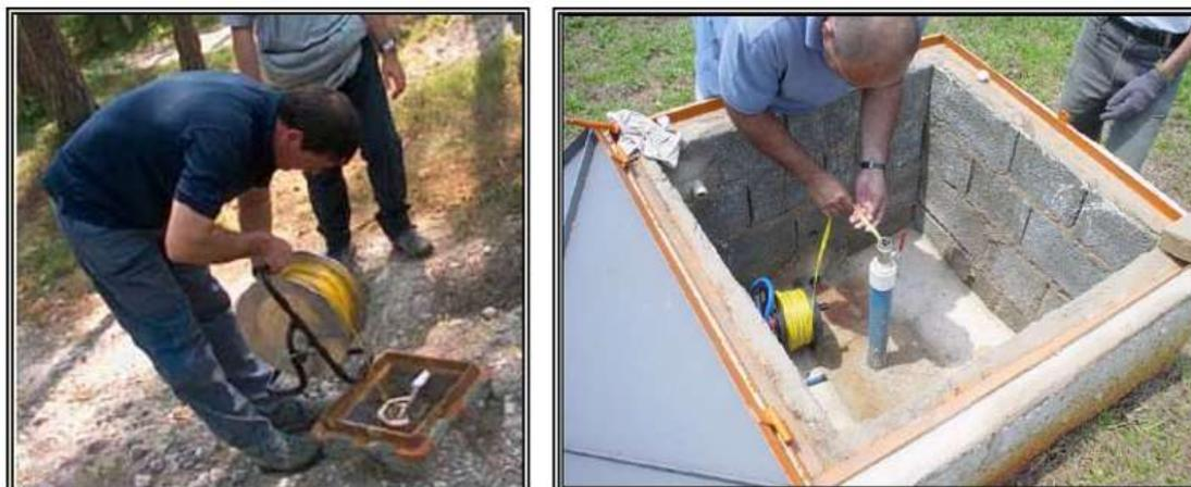
Figura 19: Leitura do Piezômetro Tubo Aberto
