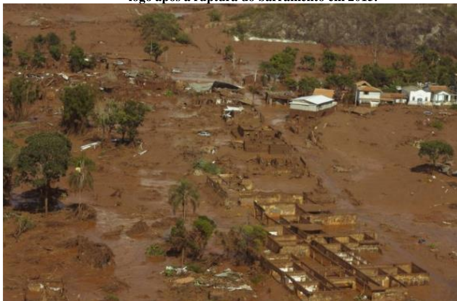
Figura 7 – Foto do vale a jusante da barragem de Fundão (Brasil) afetado pelo deslocamento do rejeito logo após a ruptura do barramento em 2015.
