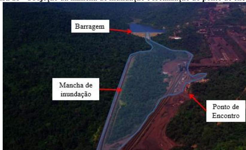
Figura 18 – Projeção da mancha de inundação e localização do ponto de encontro.
