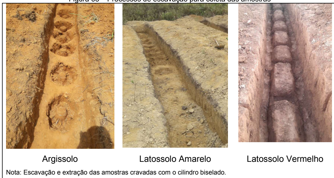
Figura 68 – Processos de escavação para coleta das amostras
