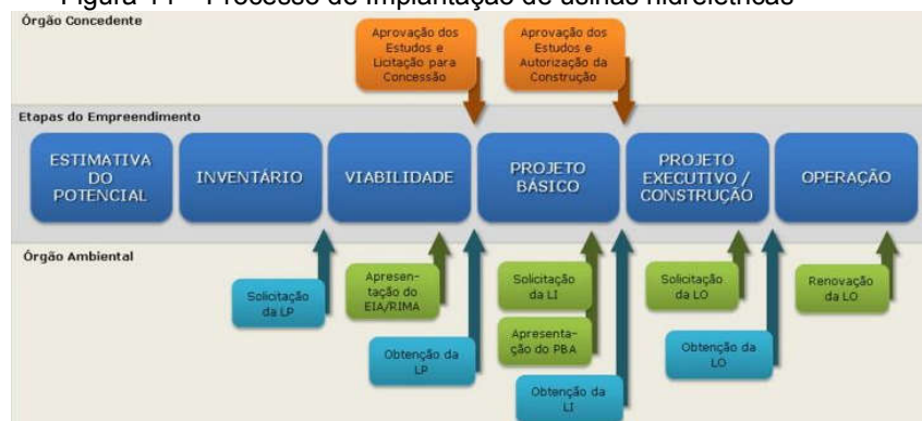
Figura 14 – Processo de Implantação de usinas hidrelétricas
