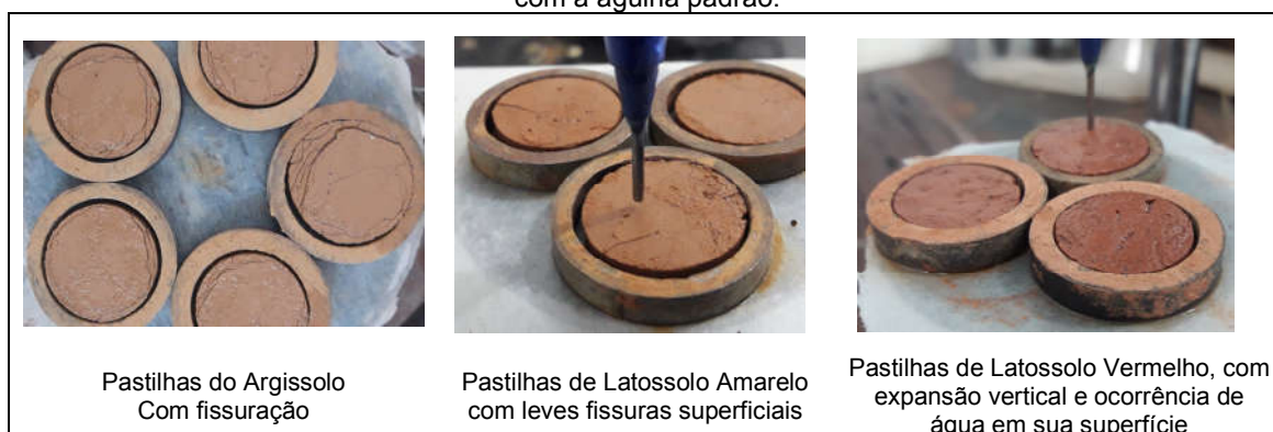
Figura 63 – Procedimento de registro das condições das pastilhas após reabsorção e de penetração com a agulha padrão.
