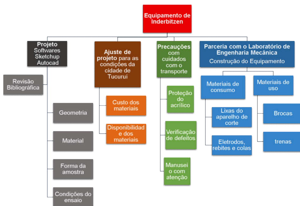
Figura 96 – Principais etapas da construção do equipamento de Inderbitzen.
