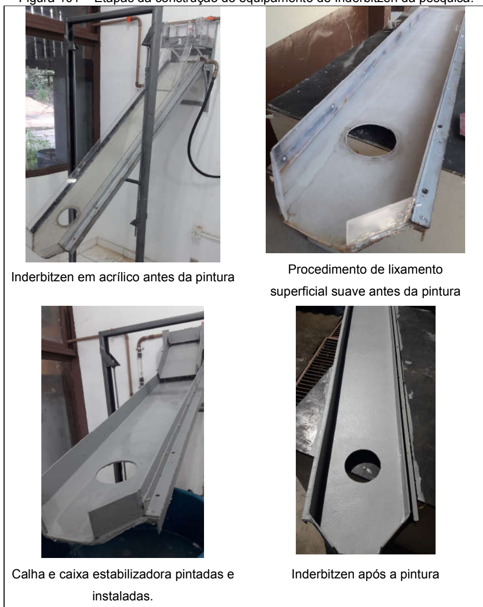
Figura 101 – Etapas da construção do equipamento de Inderbitzen da pesquisa.
