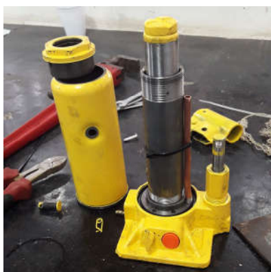
Modificação do sistema hidráulico do Macaco de cravação
