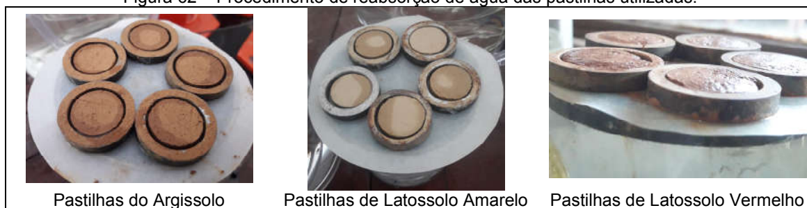
Figura 62 – Procedimento de reabsorção de água das pastilhas utilizadas.
