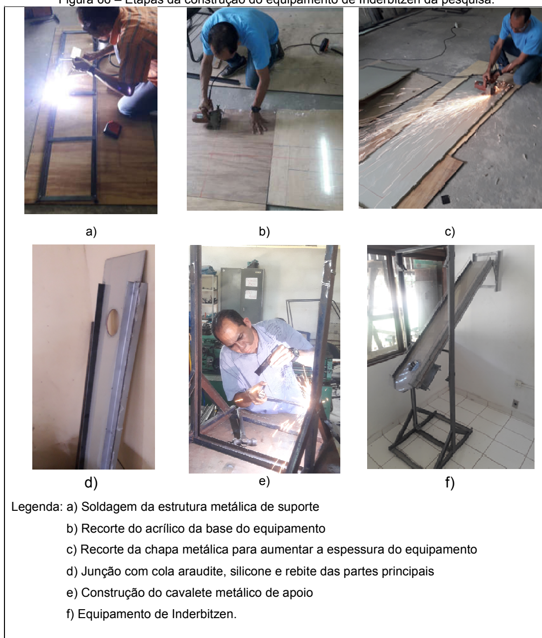
Figura 66 – Etapas da construção do equipamento de Inderbitzen da pesquisa.
