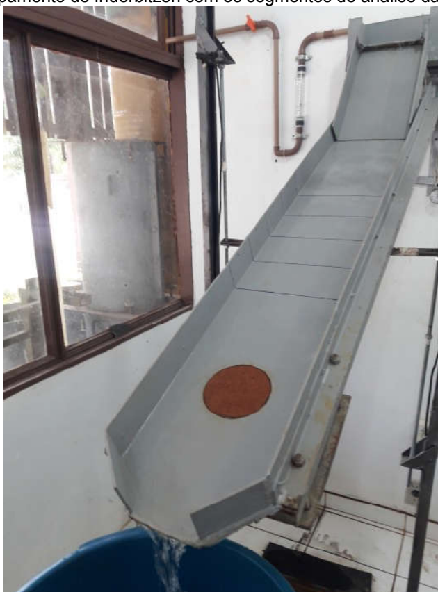
Figura 102 – Equipamento de Inderbitzen com os segmentos de análise da velocidade.
