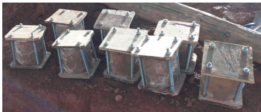
Figura 59 – Amostras indeformadas coletadas e protegidas com papel filme prontas para o transporte.
