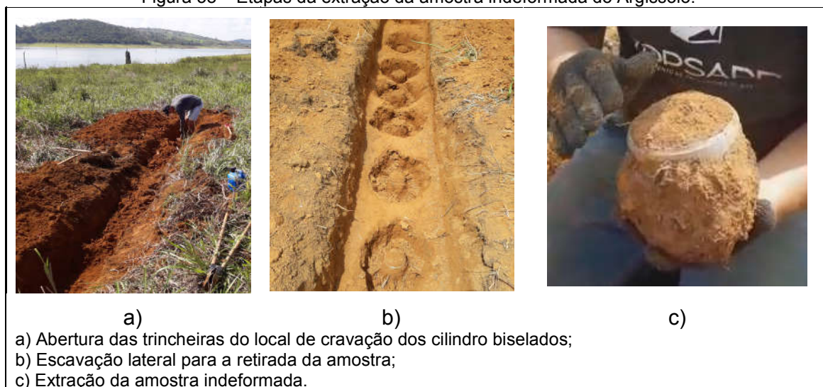
Figura 58 – Etapas da extração da amostra indeformada do Argissolo.
