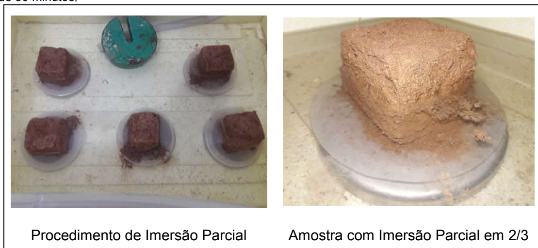
Figura 64 – Ensaio de desagregação da amostra do Argissolo por imersão Parcial, após um período de 30 minutos.
