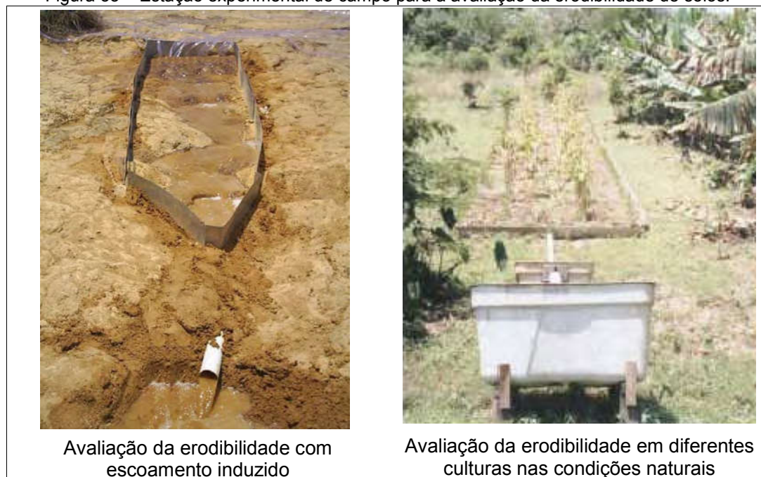
Figura 33 – Estação experimental de campo para a avaliação da erodibilidade de solos.
