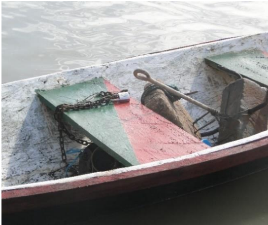
Foto 15: Âncora e pedra para apoite.
