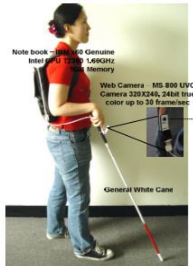
Figura 15: Protótipo do Eyecane. Adaptado de Ju et al (2010).
