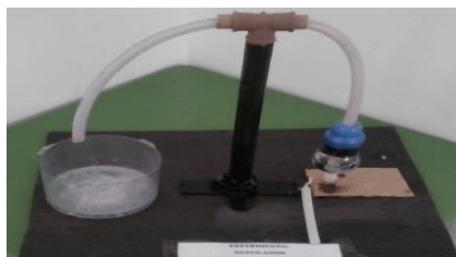
Imagem 01: Protótipo do destilador caseiro Fonte: Autora da pesquisa
