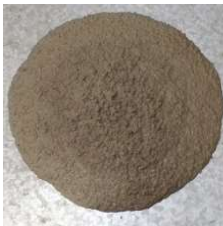
Figura 56. Espalhamento do CAA com 30% AMRC
