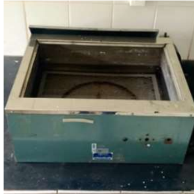
Figura 21. Tanque para imersão
