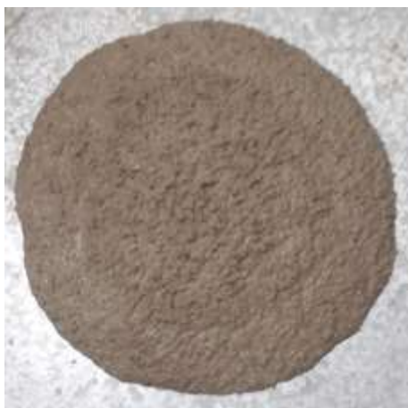
Figura 55. Espalhamento do CAA com 20% AMRC
