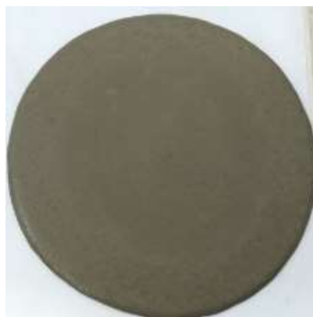
Figura 49. Argamassa com 10% de AMRC.
