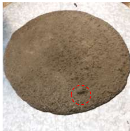
Figura 54. Espalhamento do CAA com 10% AMRC.
