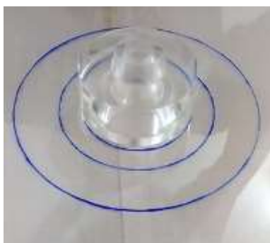
Figura 25. Cone sob a placa de vidro
