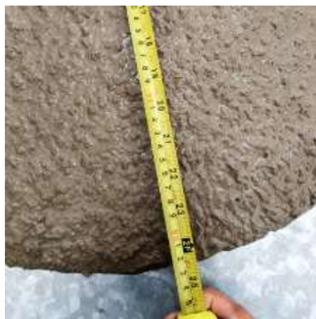
Figura 34. Espalhamento do CAA com volume de pasta de = 40%.
