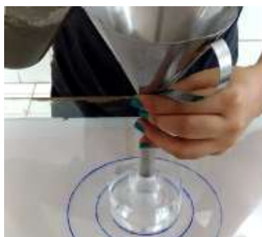
Figura 26. Enchimento do cone.
