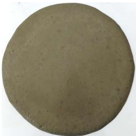
Figura 50. Argamassa com 20% de AMRC.
