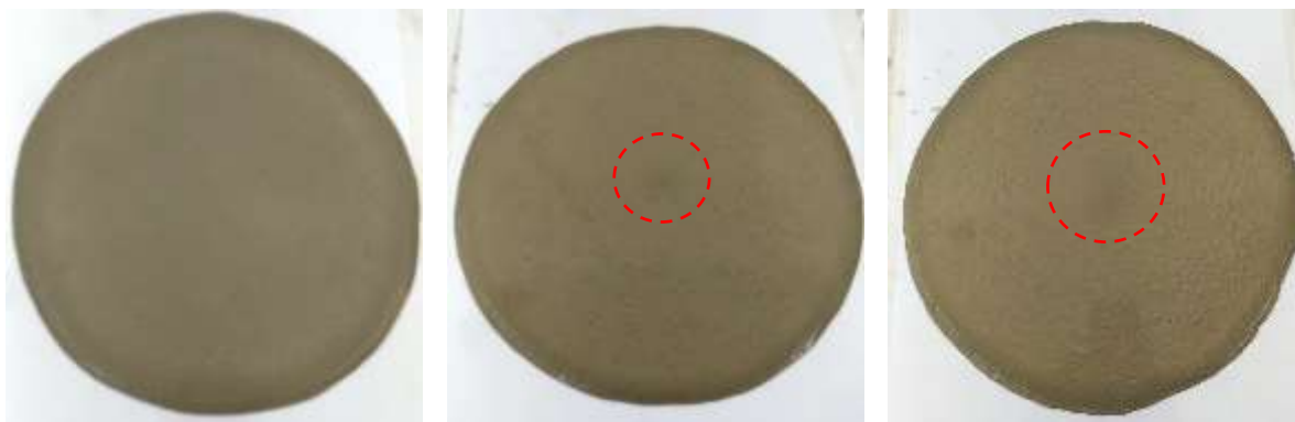
Figura 45. Argamassa com sp/c 0,6%.
