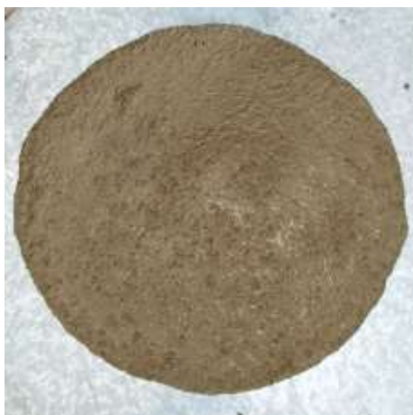
Figura 53. Espalhamento do CAA com 0% AMRC.
