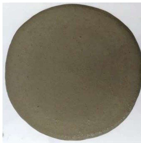
Figura 51. Argamassa com 30% de AMRC*.
