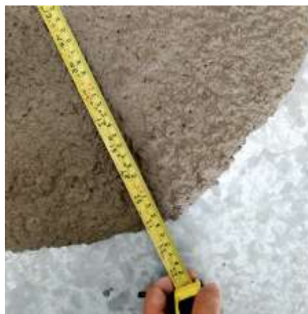
Figura 32. Espalhamento do CAA com volume de pasta de 38%
