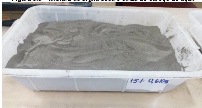
Figura 3.9 – Mistura de argila seca e cinza do caroço de açaí.
