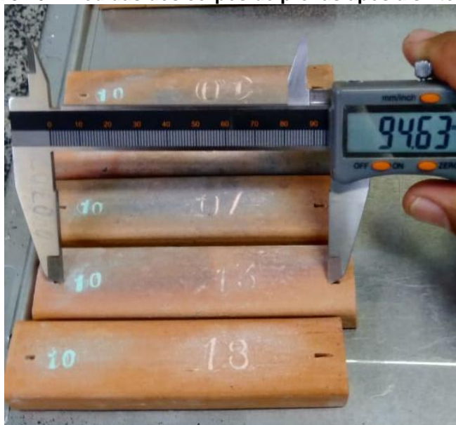
Figura 3.16 – Medidas dos corpos de provas após a sinterização
