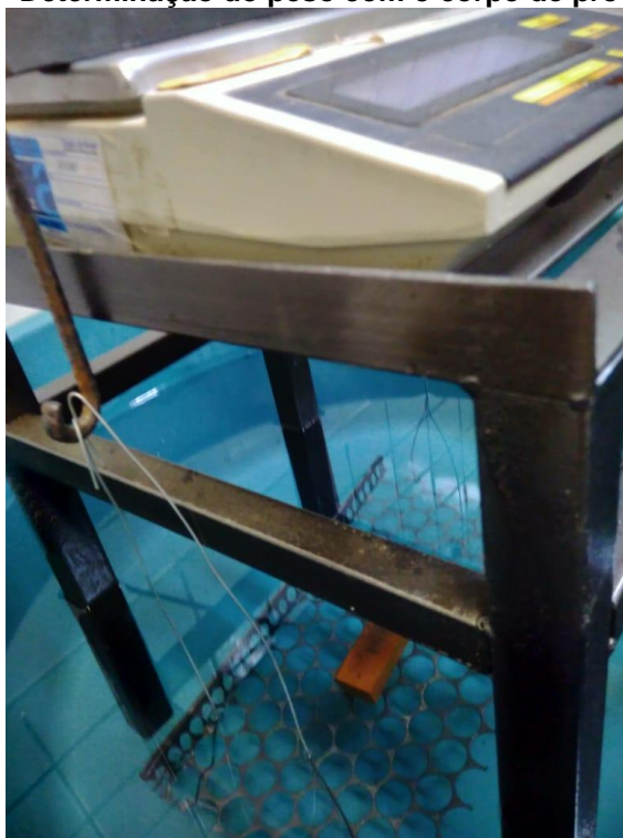
Figura 3.15 – Determinação do peso com o corpo de prova submerso.
