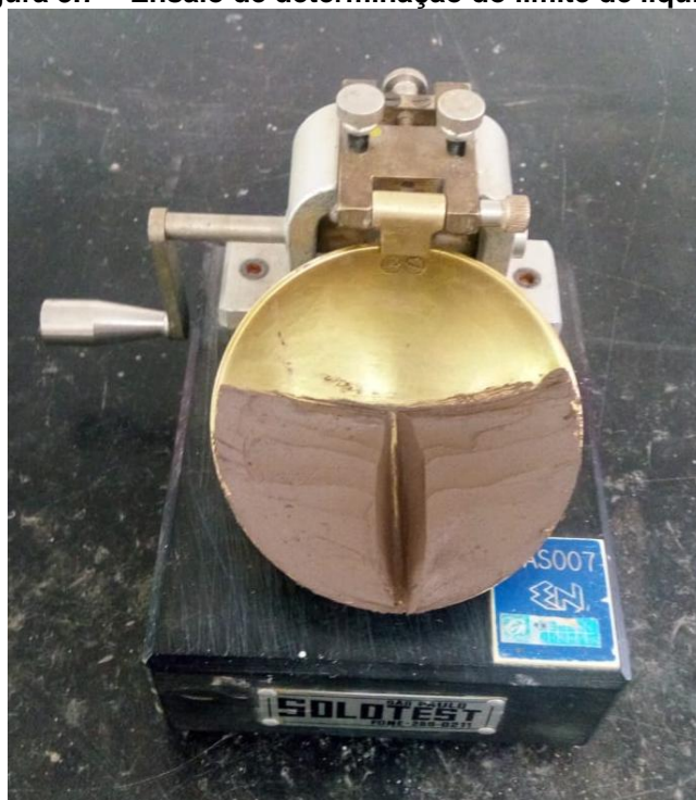
Figura 3.7 – Ensaio de determinação do limite de liquidez.
