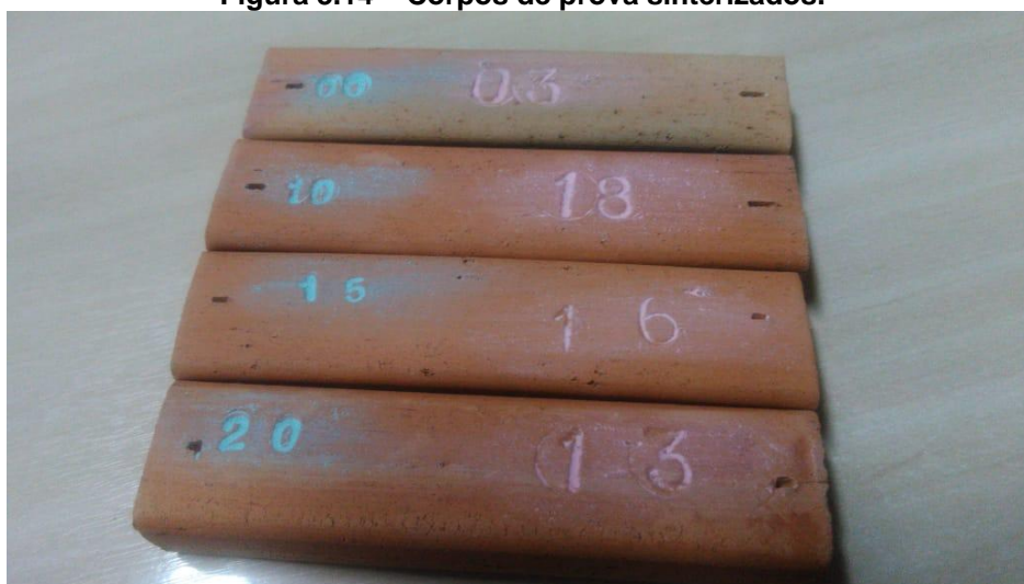
Figura 3.14 – Corpos de prova sinterizados.
