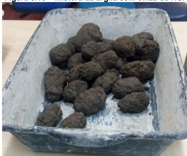
Figura 3.10 – Mistura da argila com cinza de RCA.
