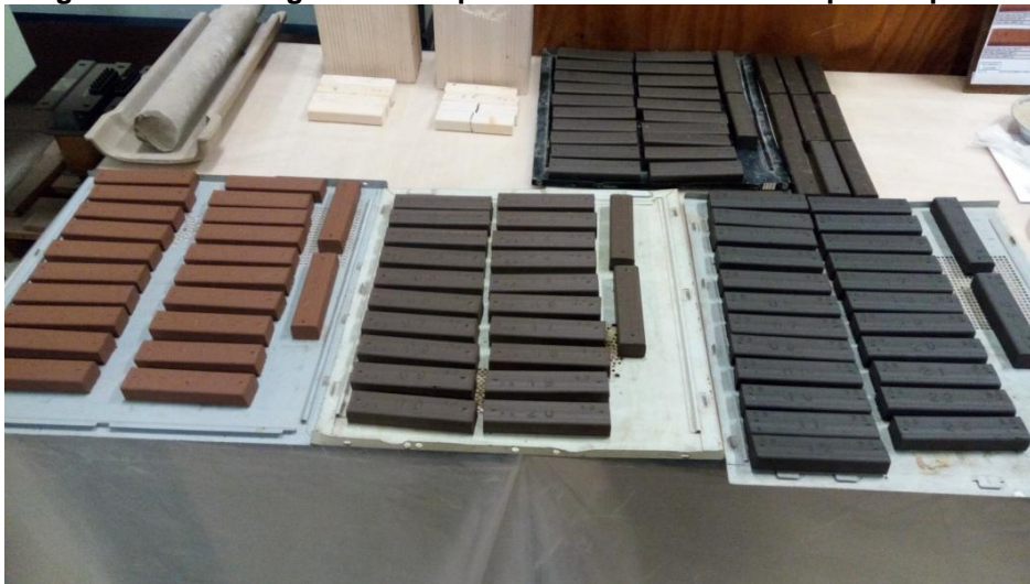
Figura 3.12 – Secagem em temperatura ambiente dos corpos de prova.
