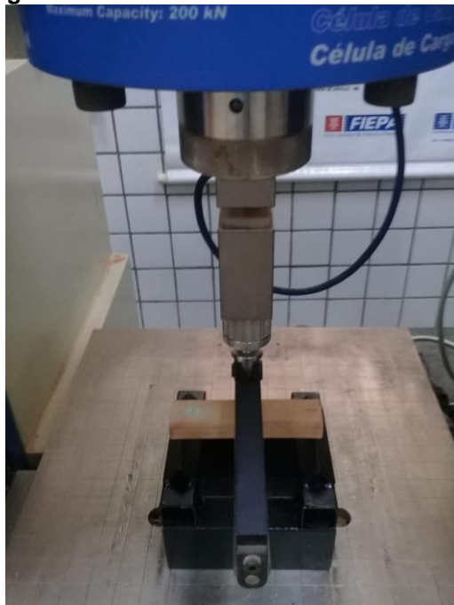
Figura 3.17 – Ensaio de resistência a flexão.
