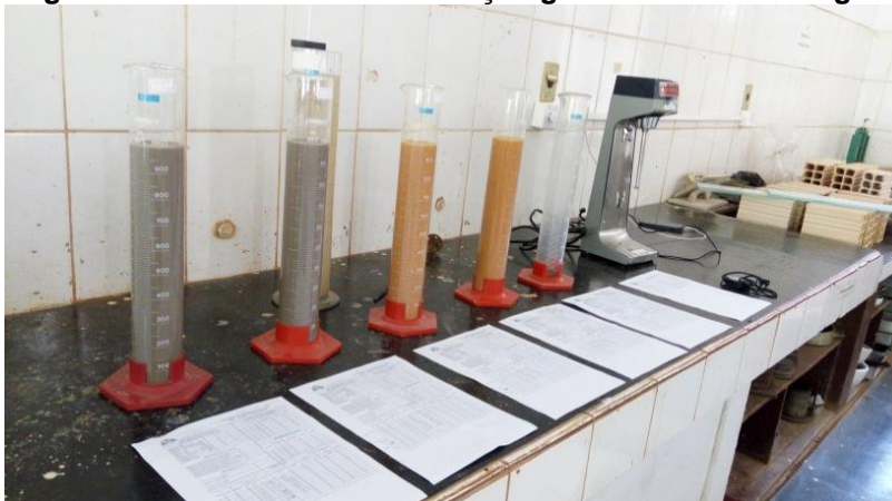
Figura 3.5 – Ensaio de determinação granulométrica da argila.
