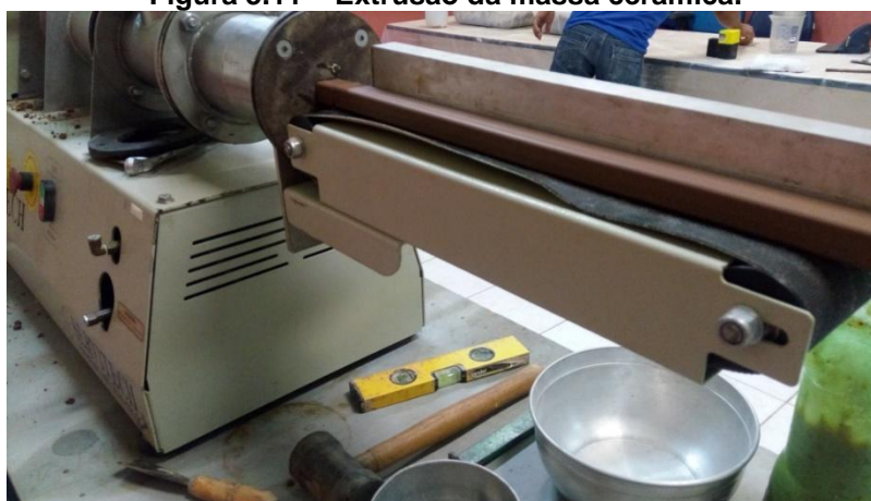
Figura 3.11 – Extrusão da massa cerâmica.
