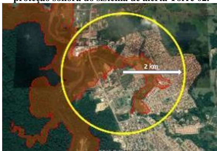
Figura 38 - Configuração da mancha de inundação no bairro Jardim Tropical e área de proteção sonora do sistema de alerta Torre 02.
