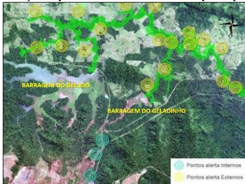
Figura 30 - Localização dos pontos de alerta instalados na ZAS pelo empreendedor.
