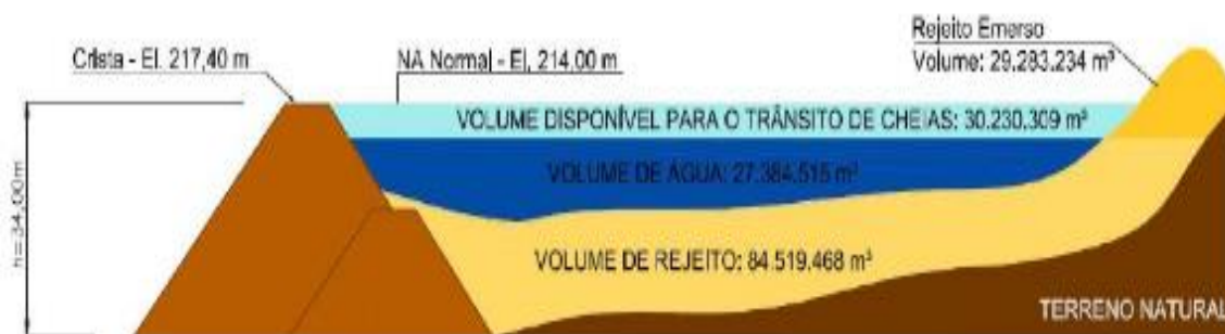
Figura 23 - Croqui da quantificação dos volumes da barragem do Gelado.
