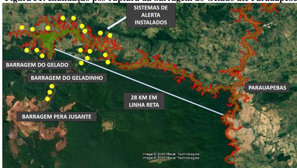
Figura 31: Inundação pós-ruptura da barragem do Gelado até Parauapebas.
