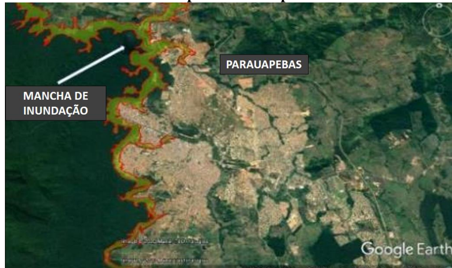
Figura 32: Visualização da inundação pós-ruptura da barragem do Gelado no município de Parauapebas.
