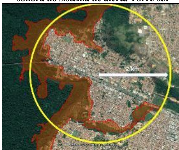
Figura 41 - Configuração da mancha de inundação no bairro União e área de proteção sonora do sistema de alerta Torre 03.
