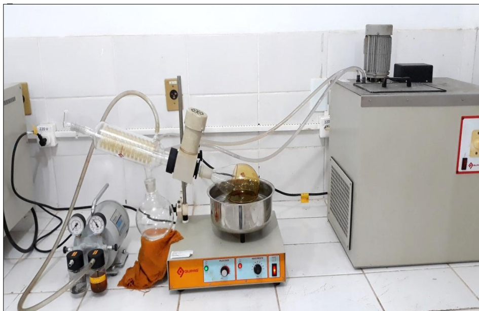
Figura 19 – Sistema de evaporação rotativa acoplado a refrigerador, método de concentração utilizado
