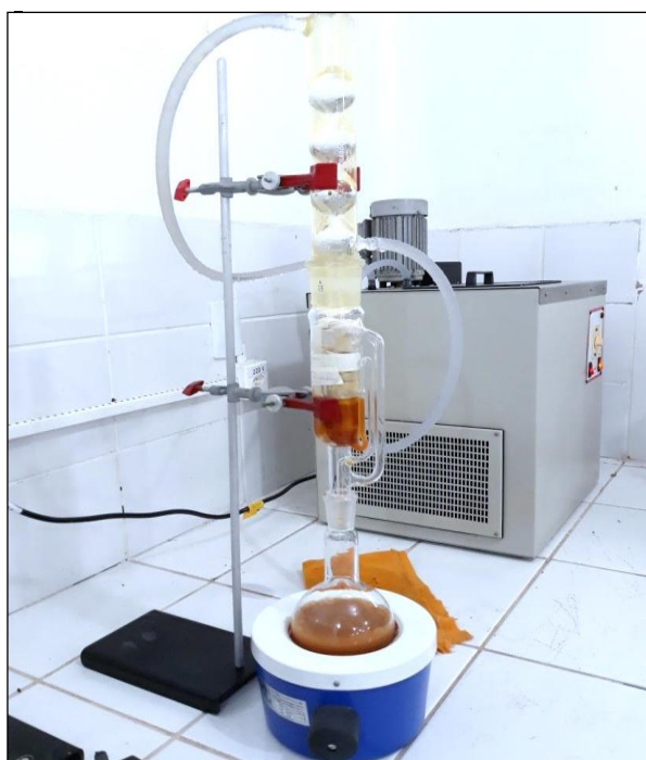
Figura 18 – Extração por Soxhlet acoplado a um sistema de refrigeração
