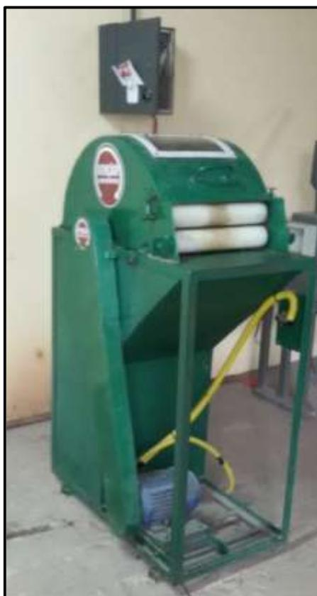
Figura 3. 6: Máquina montada de desfibrar.
