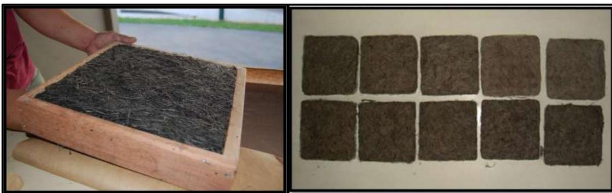
Figura 2. 11: Montagem de placa da fibra de bananeira. Fonte: Demarchi (2010).
