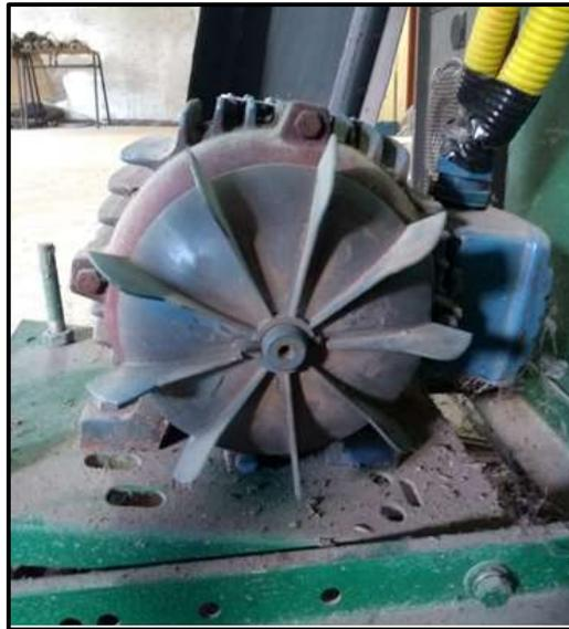
Figura 4.6: Motor TEFC da máquina de desfibrar.
