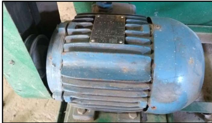
Figura 4.4: Motor elétrico da máquina de desfibrar.
