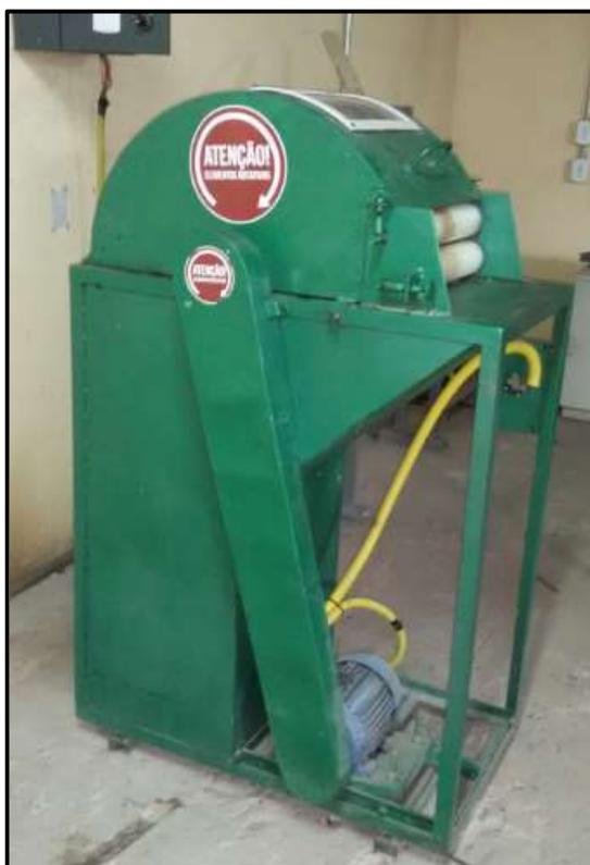
Figura 4. 1: Máquina de desfibrar sem os isoladores de vibração
