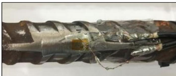
**Figura 3.7 - EER colados na barra de flexão.**
