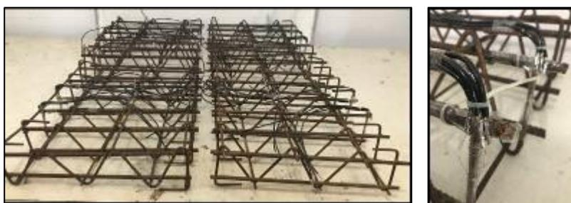
**Figura 3.9 - Instrumentação dos estribos transversal treliçado pré-fabricado.**
