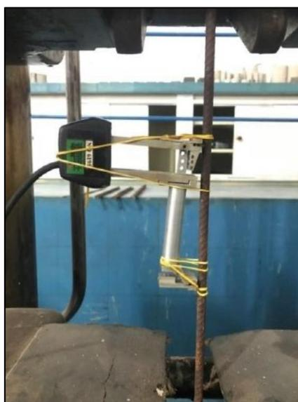
**Figura 3.14 - Ensaio do aço a tração.**
