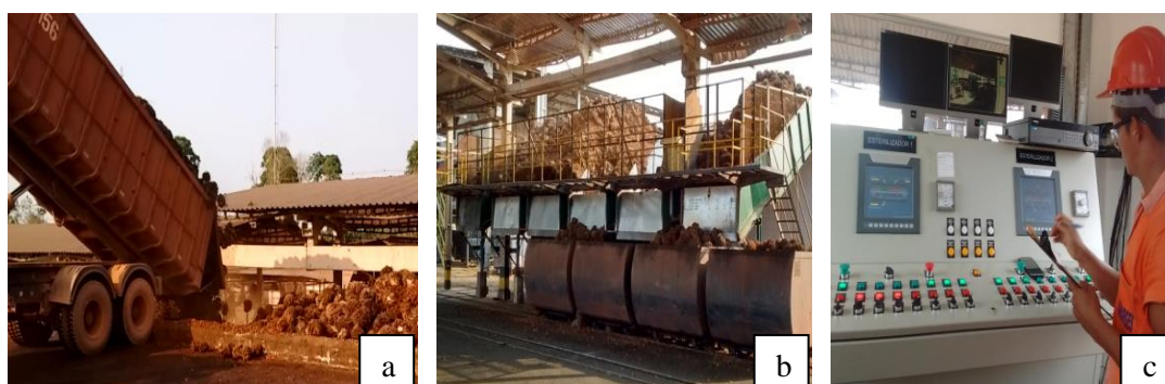
Figura 31 - Recebimento dos CFF (a), vagonetes com CFF (b) e o sistema de supervisão para a esterilização (c).
