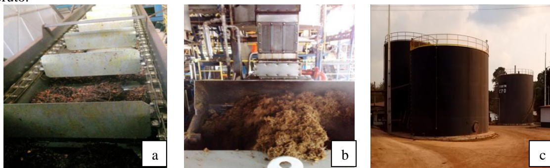
Figura 32 - Tombador (a), fibras e nozes do prensagem(b), tanque de armazenamento do óleo bruto.
