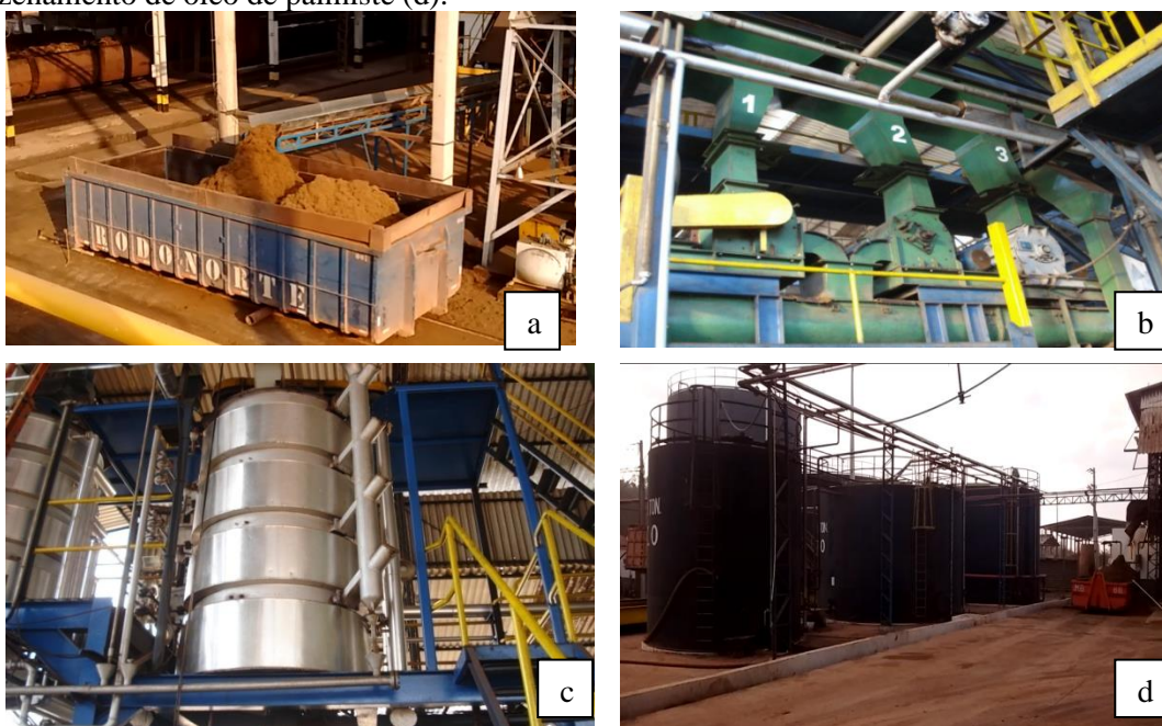
Figura 33 - Retirada das fibras (a), quebrador de nozes (b), tanque de cozimento (c) e tanque de armazenamento de óleo de palmiste (d).
