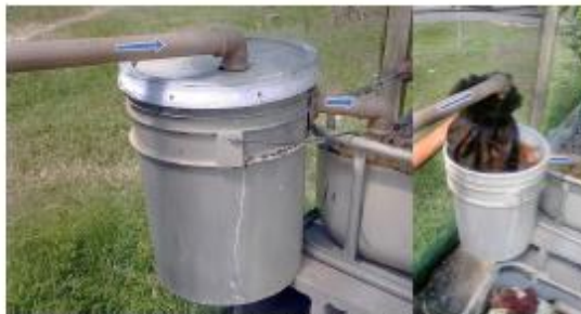
Figura 8. Filtro de sólidos em suspensão contendo pedaços de sombrite (elemento filtrante) amarrados em forma de bolsa na tubulação de entrada para conter a passagem de material fino que não foi retido pelo filtro de sólidos decantáveis.
