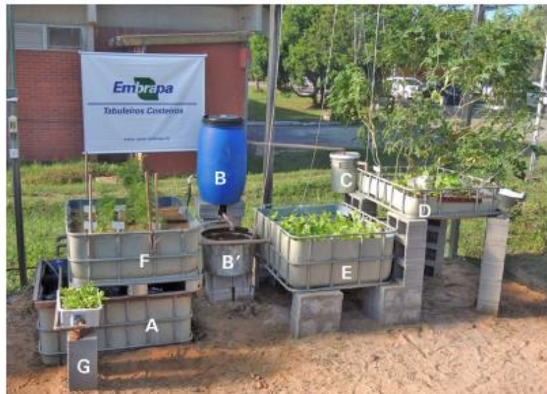
Figura 1. Sistema modular de aquaponia em nível familiar desenvolvido no Laboratório de Pesquisa em Aquaponia da Embrapa Tabuleiros Costeiros (LAPAq) que conta com (A) um tanque de criação de peixes de 600 L de volume útil, (B) um filtro de sólidos decantáveis de 200 L, (B') um mineralizador, (C) um filtro de sólidos em suspensão de 20 L e três ambientes distintos de cultivo com 1 m 2 cada: (D) ambiente de pedra brita para hortaliças que frutificam; (E) ambiente flutuante para produção de hortaliças folhosas apoiadas em placas de isopor; (F) ambiente de cultivo de raízes tuberosas em areia. (G) ambiente para produção de mudas em areia.
