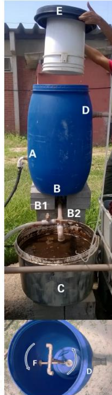
Figura 7. Filtro de sólidos decantáveis feito a partir de um tambor plástico de 100 L. (A) Flange de 20 mm de entrada da água vinda da caixa de criação dos peixes. (B) Saída (32 mm) inferior para a retirada do material orgânico decantado. (B1) Registro para facilitar o retorno da água limpa à caixa dos peixes durante procedimento de limpeza. (B2) Registro para a retirada do material decantado ao final do processo de limpeza. (C) Mineralizador. (D) Flange de 32 mm na saída do filtro de sólidos decantáveis. (E) Balde de 20 L instalado de cabeça para baixo entre a entrada da água e sua saída para fazer o barramento e desvio do fluxo da água, contribuindo para a decantação dos sólidos mais pesados e sua retenção no filtro. (F) Vista interna do filtro de sólidos decantáveis mostrando a entrada da água vinda da caixa de criação dos peixes em tubulação de 20 mm instalada de forma a permitir fluxo circular da água e facilitar a decantação dos sólidos mais pesados.
