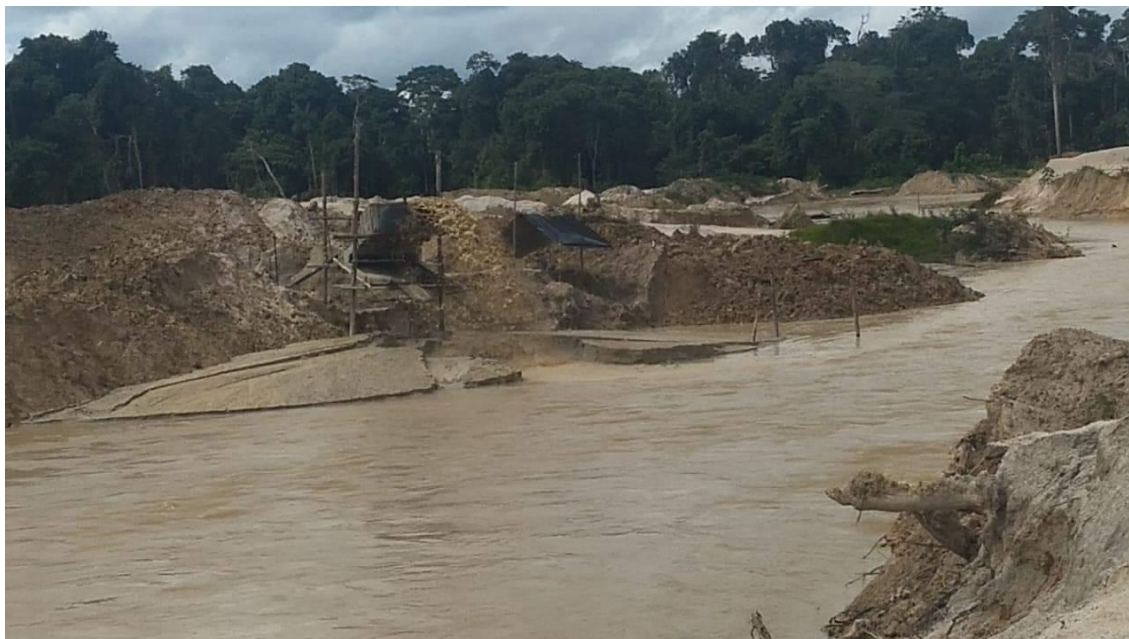
Figura 49: Toneladas de terra jogadas na água ocasionam o assoreamento dos rios no Megagarimpo no rio das Tropas, dentro do território Munduruku
