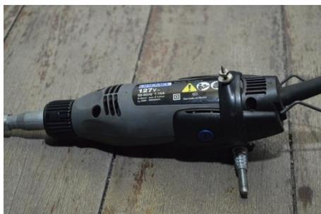
FIGURA 137 - Retífica Dremmel com abraçadeira adaptada para corte em 'círculo'
