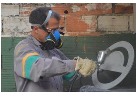
FIGURA 157 - Instantâneo de pintura de placa de PVC
