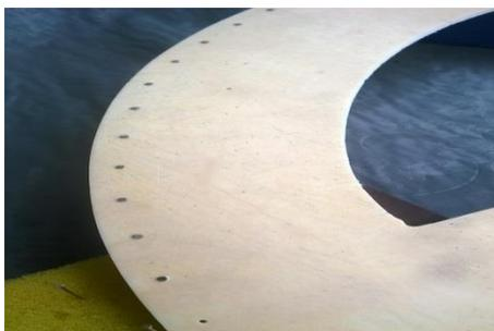
FIGURA 146 - Alfinete como relevo em placa PVC pré pintura
