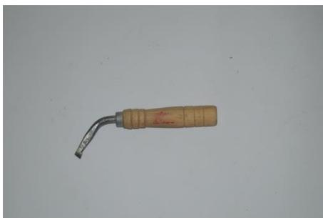
FIGURA 140 - Cortador cônico para placas em PVC
