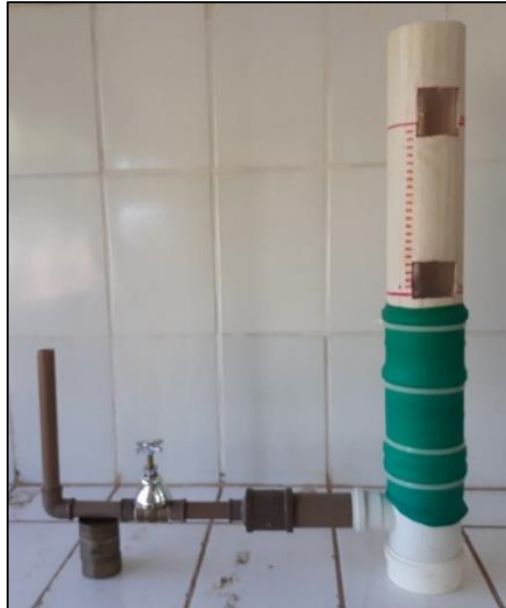
Figura 3.4 – Permeâmetro de carga variável utilizado.
