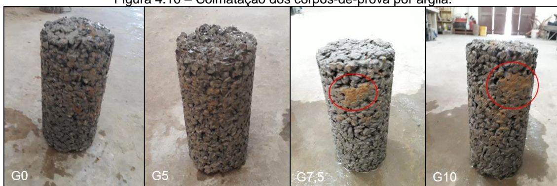
Figura 4.10 – Colmatação dos corpos-de-prova por argila.
