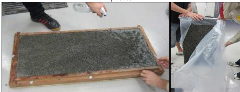
Figura 2.7 – Cura com (a) a aspersão de água e (b) cobertura da superfície livre com material plástico.
