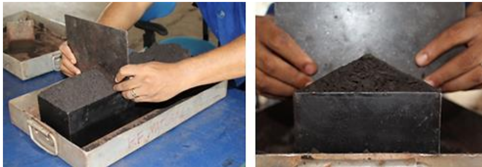
Figura 3.13 – Formação da altura e ângulo da pila de material. Fonte: Autoria própria, 2018.
