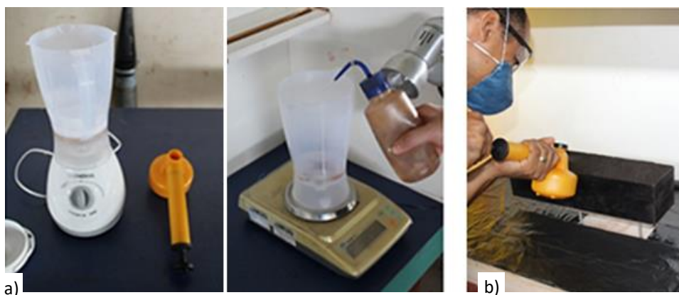
Figura 3.14 – a) Procedimento de preparo da solução aquosa; b) Aplicação da solução sobre a superfície do material. Fonte: Autoria própria, 2018.
