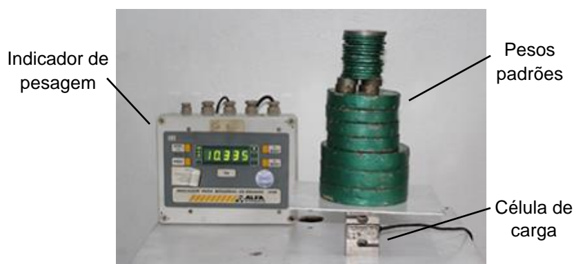
Figura 3.6 – Sistema para calibração da célula de carga. Fonte: Autoria própria, 2018.
