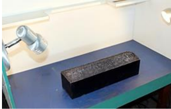
Figura 3.15 – Cura do reagente aplicado na superfície do material. Fonte: Autoria própria, 2018.
