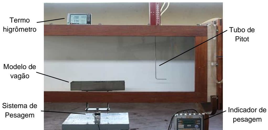
Figura 3.9 – Instrumentos de medição instalados na seção de teste do túnel de vento. Fonte: Autoria própria, 2018.
