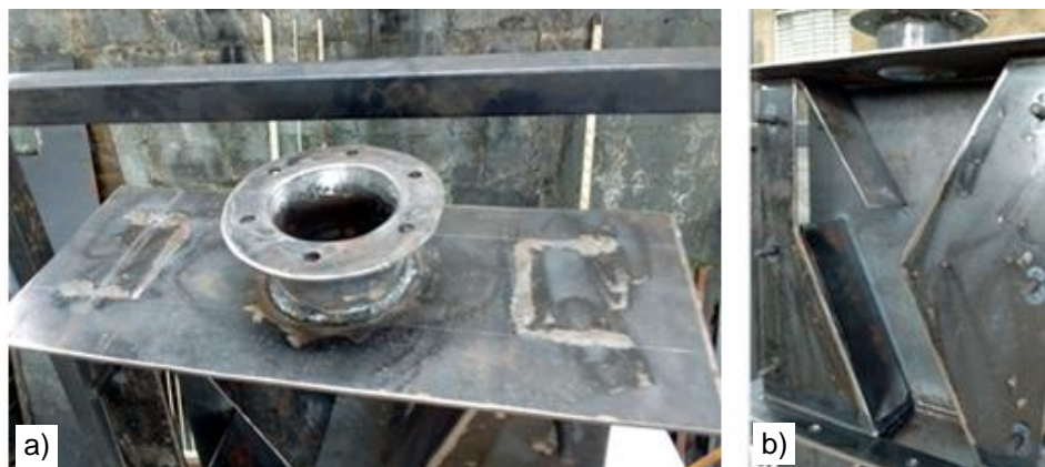
Figura 3.19 – a) Entrada superior da torre de poeira, para alimentação da amostra de ensaio; b) Entrada da tubulação lateral de sucção. Fonte: Autoria própria, 2018.
