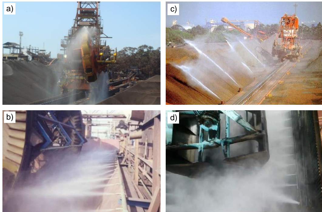
Figura 2.37 – Sistemas de aspersão de água.
