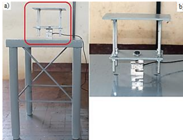
Figura 3.5 – a) Sistema de medição do vagão; b) detalhe do suporte do vagão. Fonte: Autoria própria, 2018.
