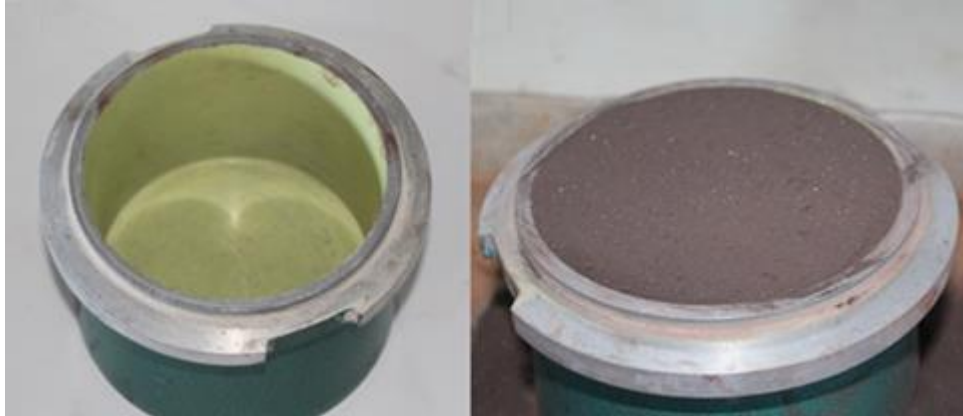
Figura 4.8 – Recipiente utilizado para medição da massa específica aparente. Fonte: Autoria própria, 2018.
