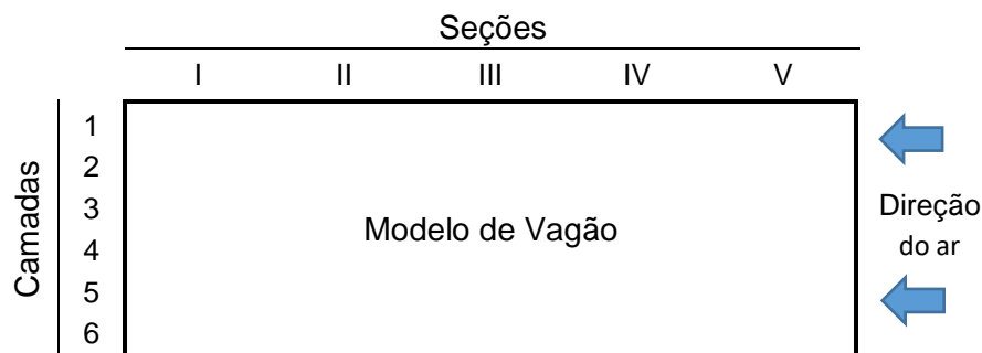
Figura 3.16 – Metodologia estratificada de coleta de amostras de material para avaliação de umidade.
