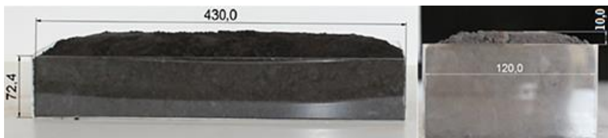
Figura 3.4 – Modelo de vagão construído em escala 1:20 (dimensões em mm). Fonte: Autoria própria, 2018.
