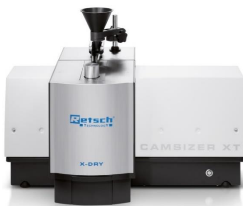
Figura 4.5 – Aparato de análise de imagem dinâmica – CAMSIZER. Fonte: Retsch Technology, 2018.
