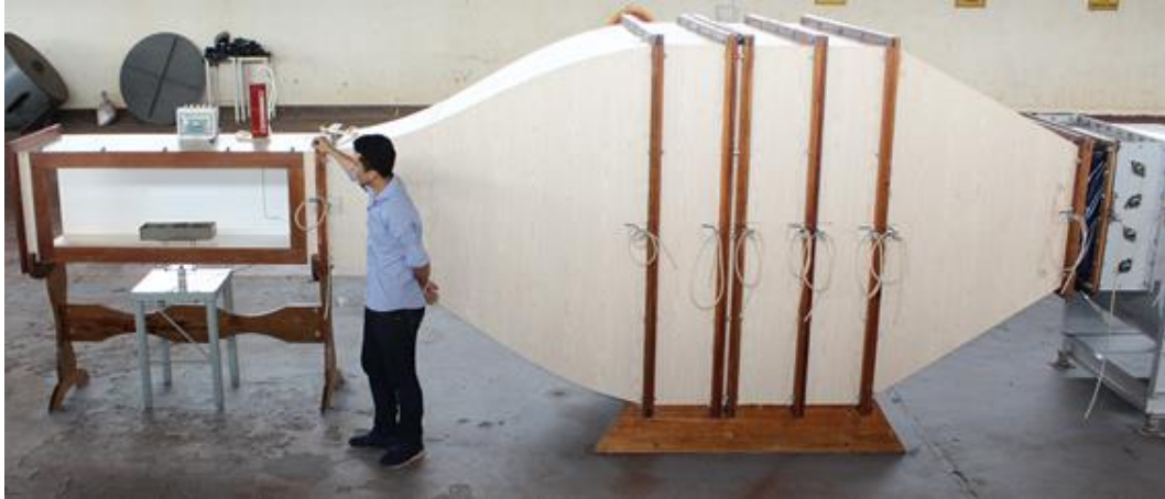
Figura 3.10 – Bancada de ensaios de arrasto eólico em túnel de vento. Fonte: Autoria própria, 2018.
