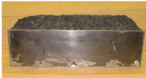
Figura 2.51 – Modelo de vagão, em escala 1:25, carregado de minério de ferro. Fonte: Leal Filho et al., 2011.
