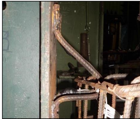
Figura 2.21 – Conector treliçado estudado por Chater (2015) Fonte: (CHATER, 2015)
