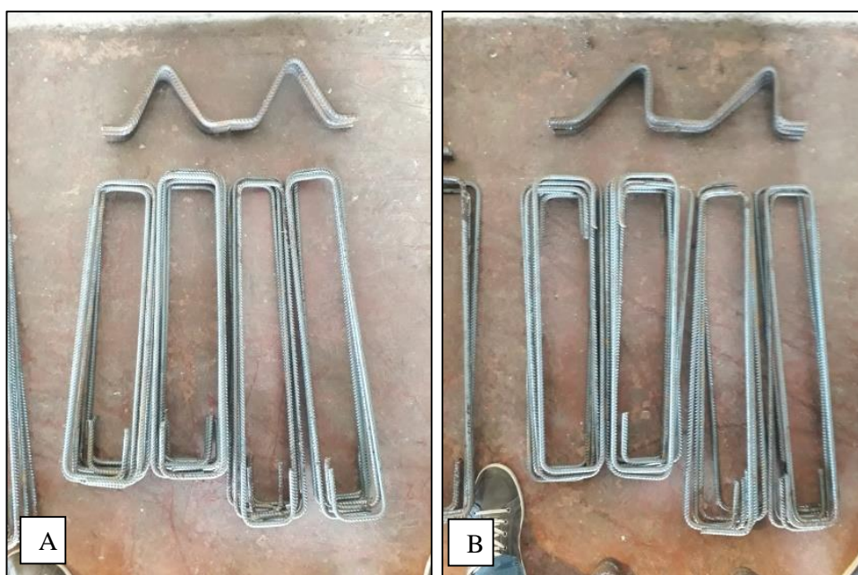
Figura 3.9 – Armaduras espécimes (A) TI, (B) TR
