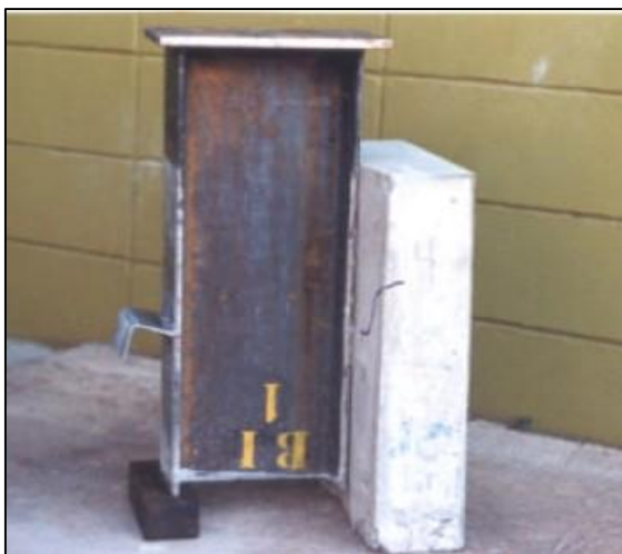
Figura 2.13 – Modelo após ensaio push-out realizado por Malite (1993) Fonte: TRISTÃO (2002)
