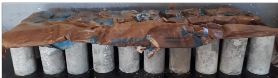
Figura 3.36 – Cura dos CPs desformafos
