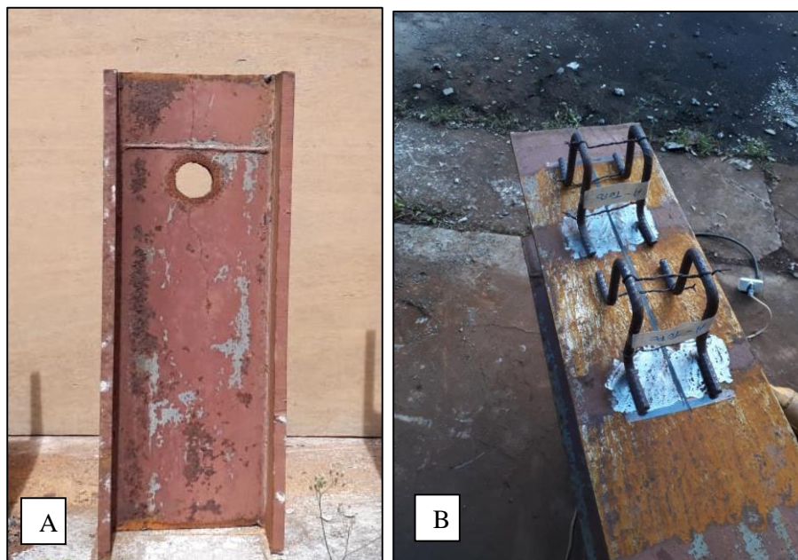
Figura 3.11 – (A) Perfil I utilizado para execução dos espécimes (B) região desbastada.
