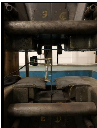
Figura 3.42 - Ensaio de tração do aço
