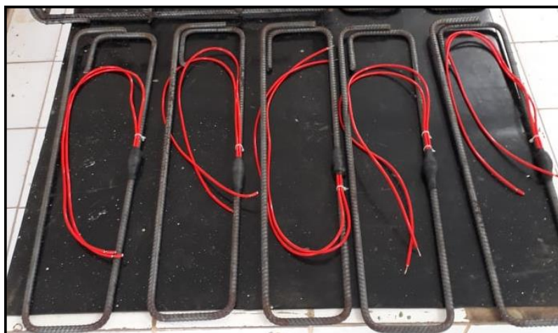
Figura 3.19 – Barra das Lajes instrumentadas
