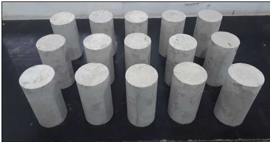
Figura 3.38 – CP's preparados para o ensaio de caracterização do concreto
