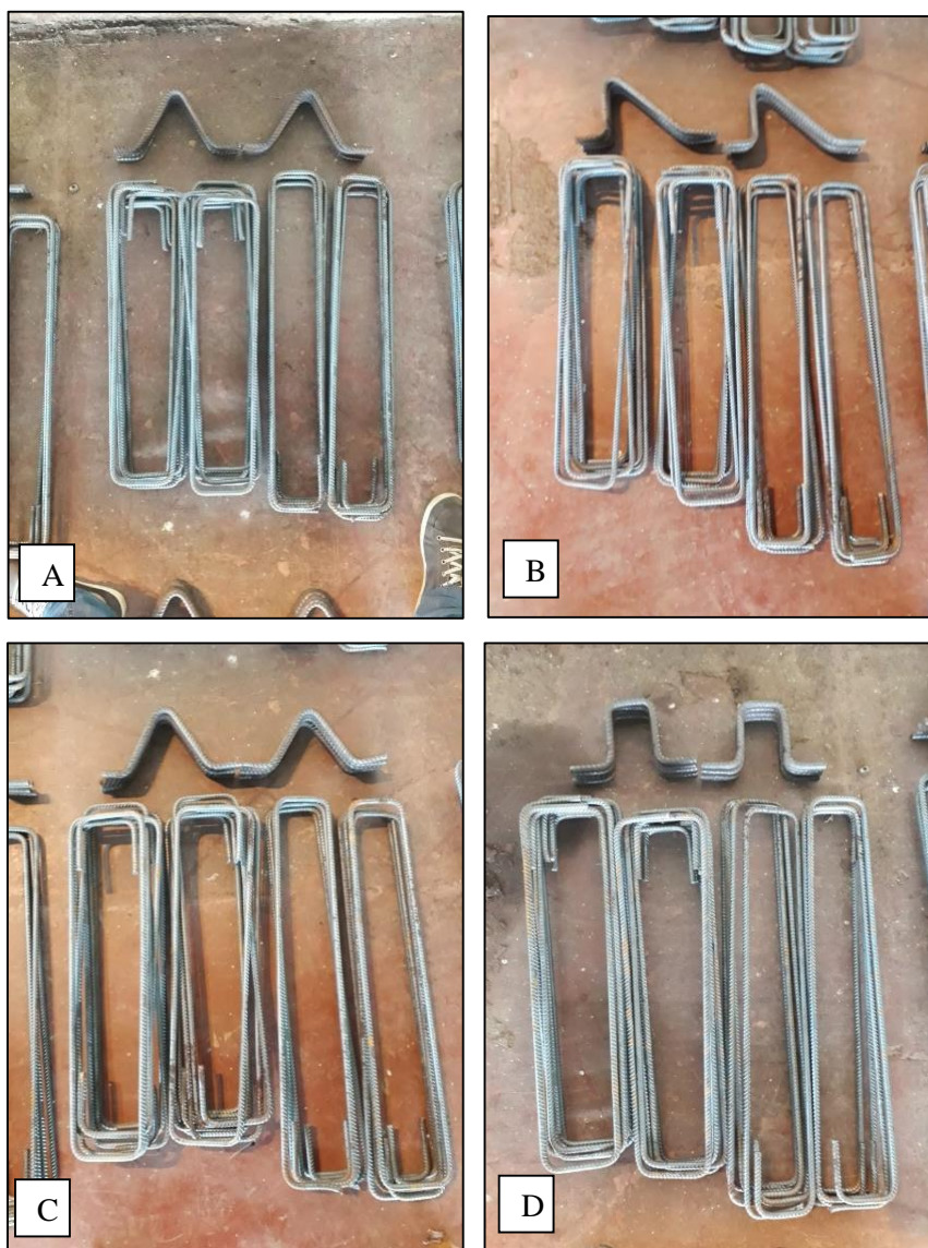
Figura 3.10 - Armaduras espécimes (A) TI-I, (B) TR-I, (C) TIP A e TIP B, (D) RT
