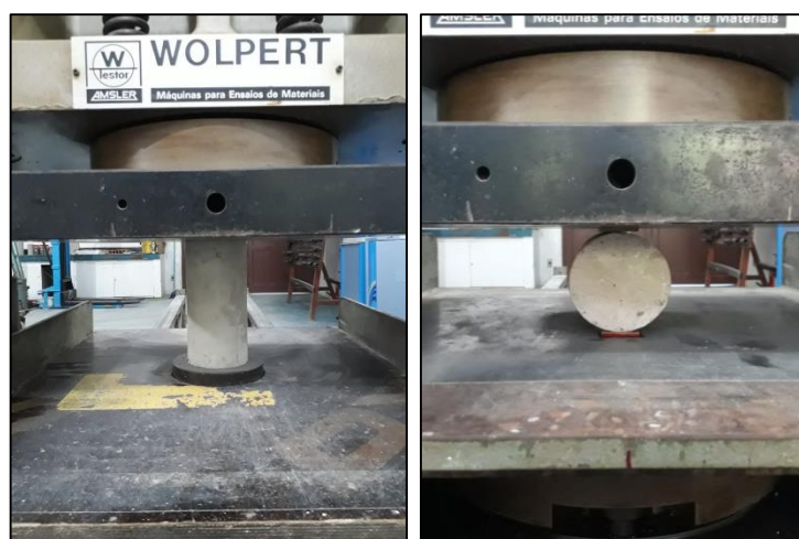
Figura 3.41 - Ensaio dos CPs. (A) Compressão centrada e (B) Tração por compressão diametral
