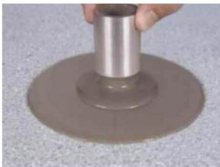
Figura 2.11 - Equipamento para a realização do o ensaio de retenção de fluxo. Fonte: Guimarães (2013).
