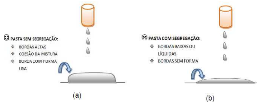
Figura 2.9 - Análise visual da argamassa escoada. (a) Argamassa sem tendência à segregação, (b) Argamassa com tendência à segregação.
