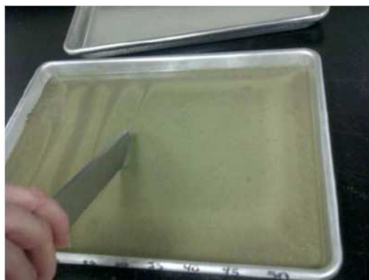
Figura 2.12 – Exemplo de corte na amostra de argamassa. Fonte: C 1708 (ASTM, 2016).
