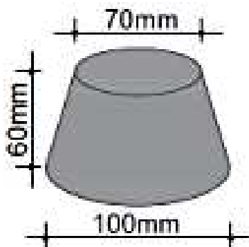
Figura 2.6 - Tronco de cone utilizado no ensaio de espalhamento. Fonte: EFNARC (2002)- Adaptado por Chaves, (2019).
