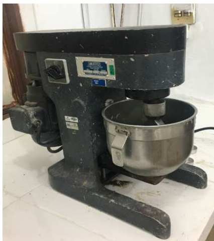
Figura 3.2 - Argamassadeira utilizada na produção das AAN's.
