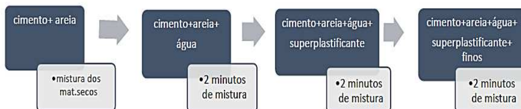
Figura 2.15 - Procedimento de mistura. Fonte: Lopes et al. (2018).
