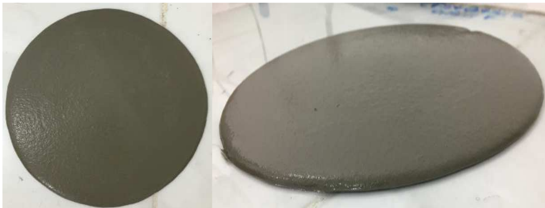
Figura A.12 - Argamassa CPV-SA10%.
