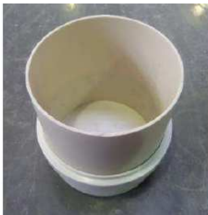
Figura 2.13 - Molde adaptado para o ensaio de exsudação. Fonte: Rubin (2015).
