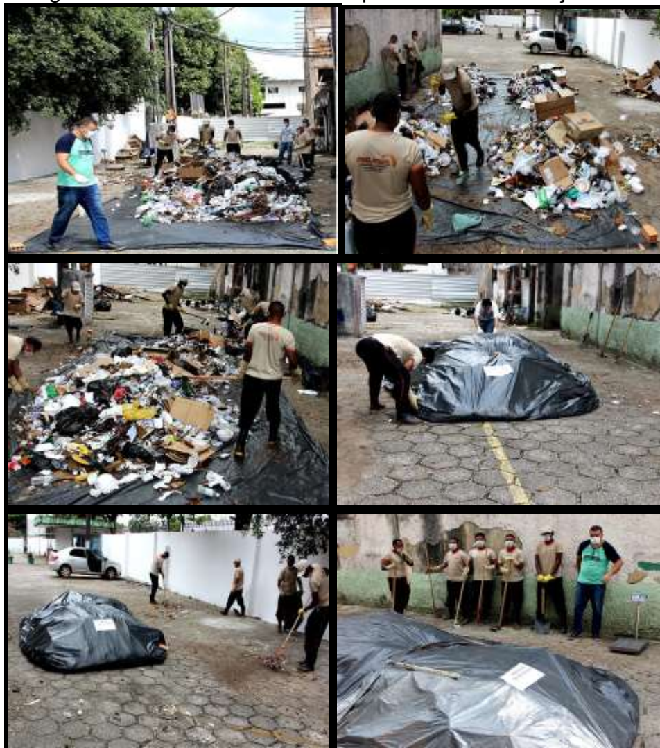
Fotografia 6 - Procedimentos do 2º quarteamento e seleção da amostra
