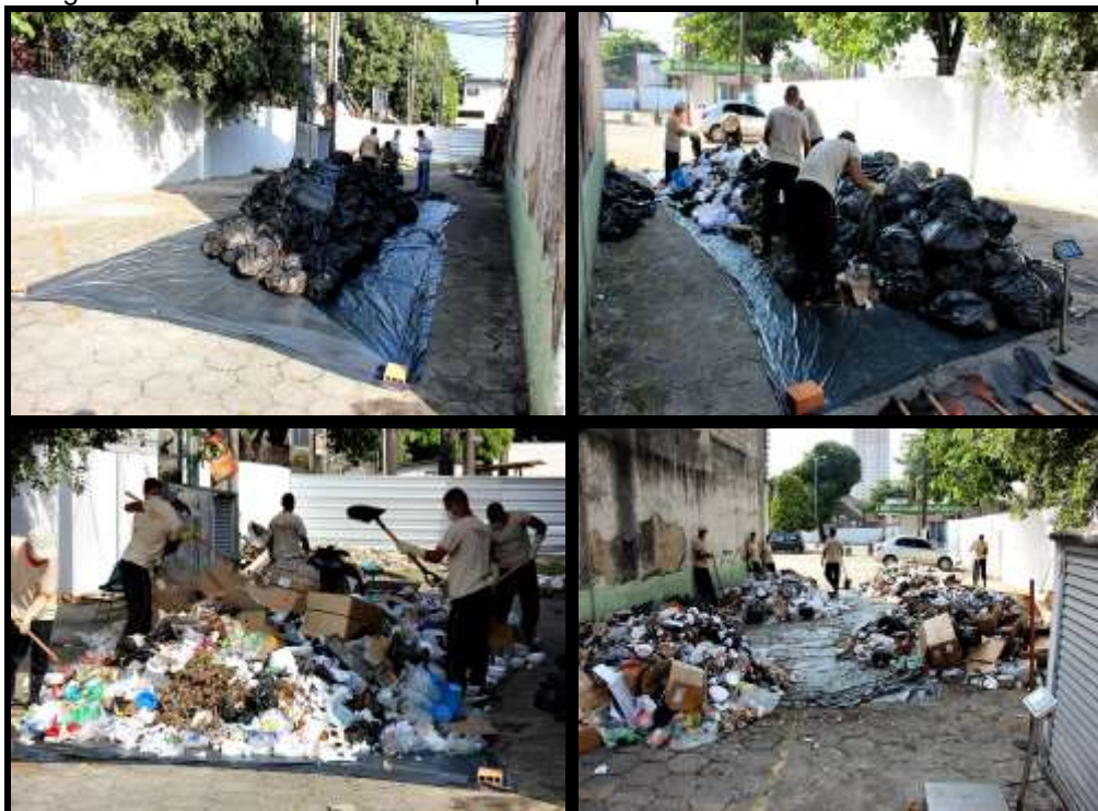
Fotografia 5 - Procedimentos do 1º quarteamento
