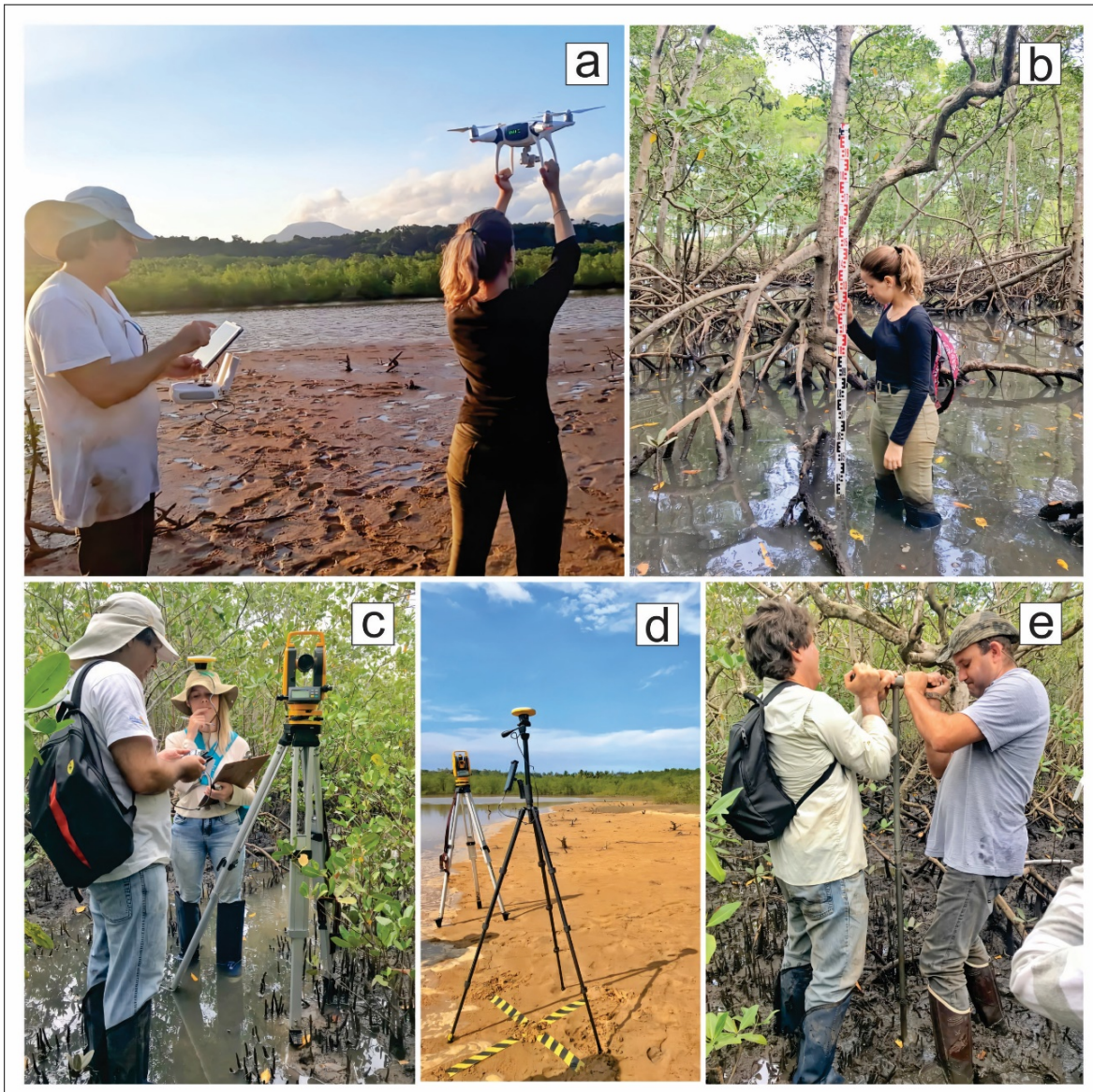
Figura 2.3- a) Sobrevoos na área de estudo com uso de drone. b e c) Uso de teodolito eletrônico para levantamento altimétrico. d) Antena Catalyst, GPS de alta precisão, para levantamento planialtimétrico. e) Amostragem dos testemunhos sedimentares com Trado Russo.
