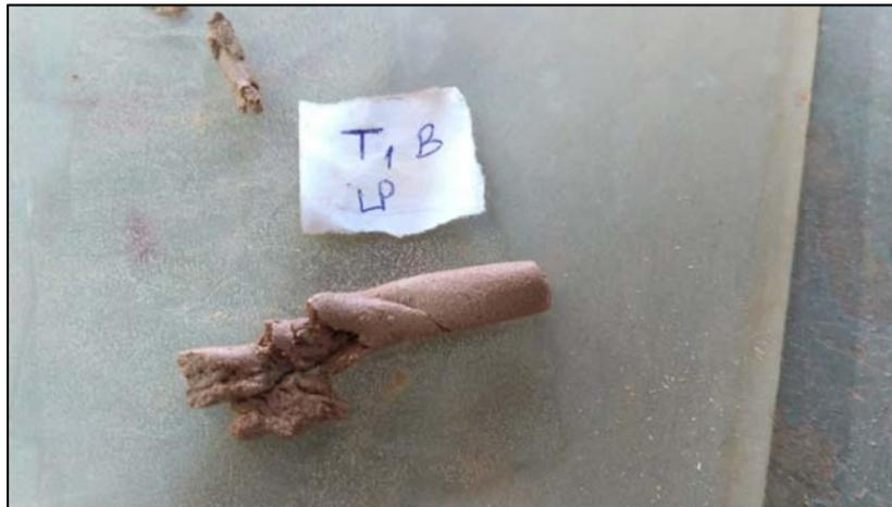
Figura 4.7. Comportamento da amostra durante o ensaio de plasticidade.
