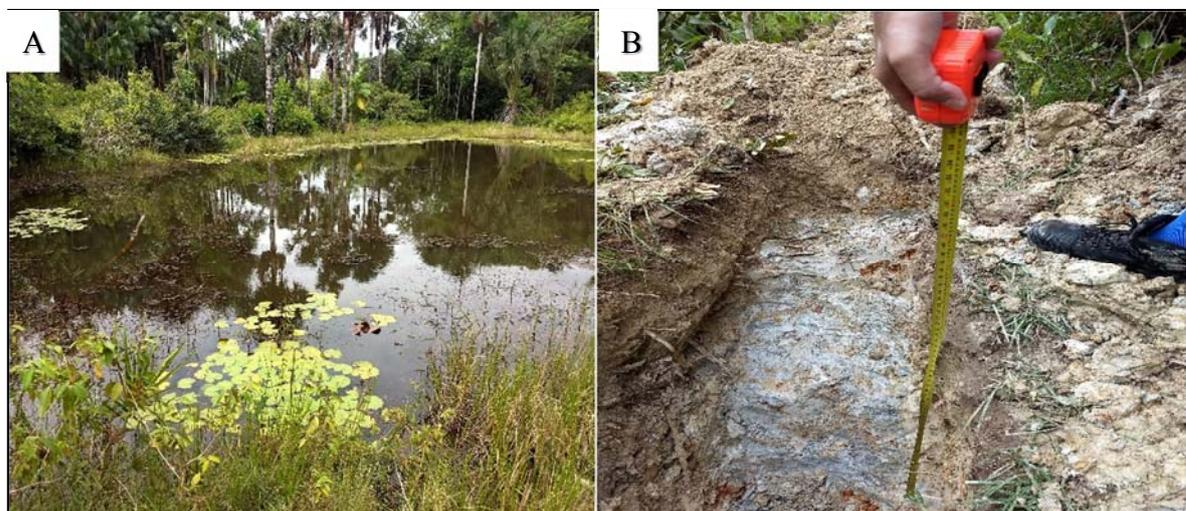
Figura 4.2. A) Cava abandonada da antiga mineradora AZPA. B) Início do horizonte glei a aproximadamente 50 cm da superfície. Ponto de coleta da Amostra 2.
