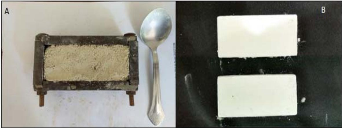
Figura 3.3. A: Material disposto na matriz metálica para prensagem. B: Corpo de prova pós prensagem.
