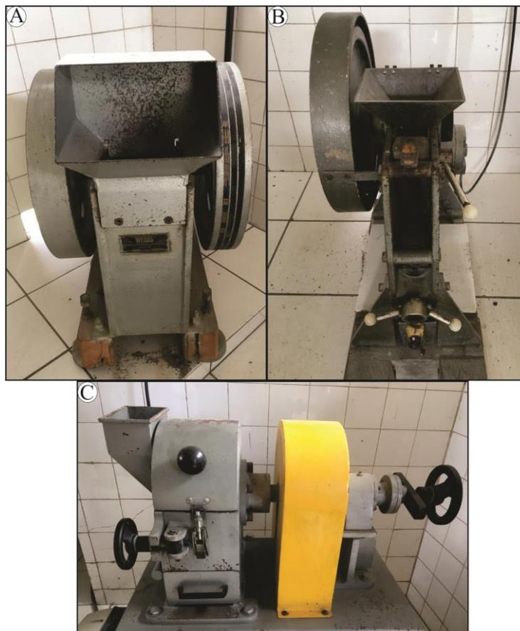
Figura 11- Equipamentos utilizados na etapa de britagem e moagem das amostras. Em (A) e (B) britadores de mandíbulas. Em (C) o moinho de discos.
