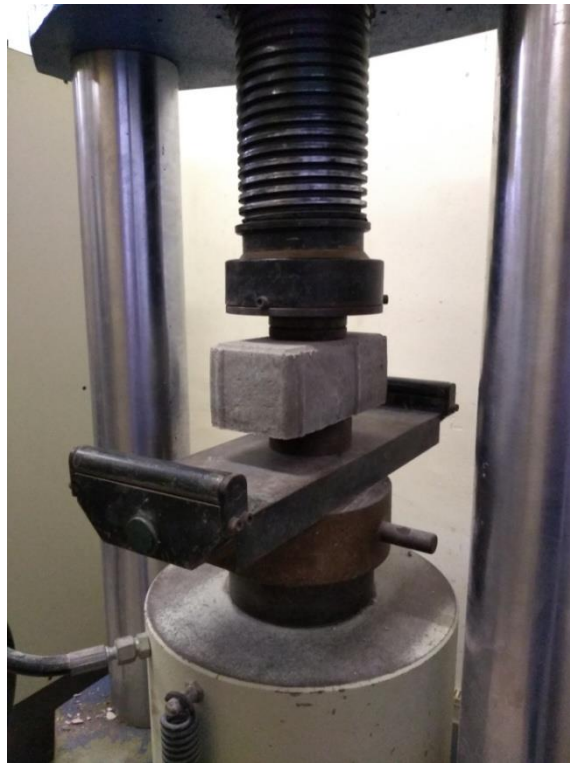
Figura 3.11 – Ensaio de resistência à compressão.
