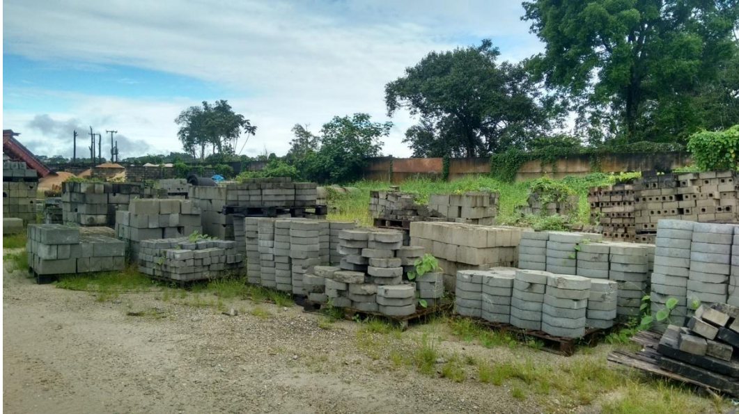
Figura 2.2– Peças pré-moldadas com avarias dispensadas pelo controle de qualidade ou por clientes (a Autora).
