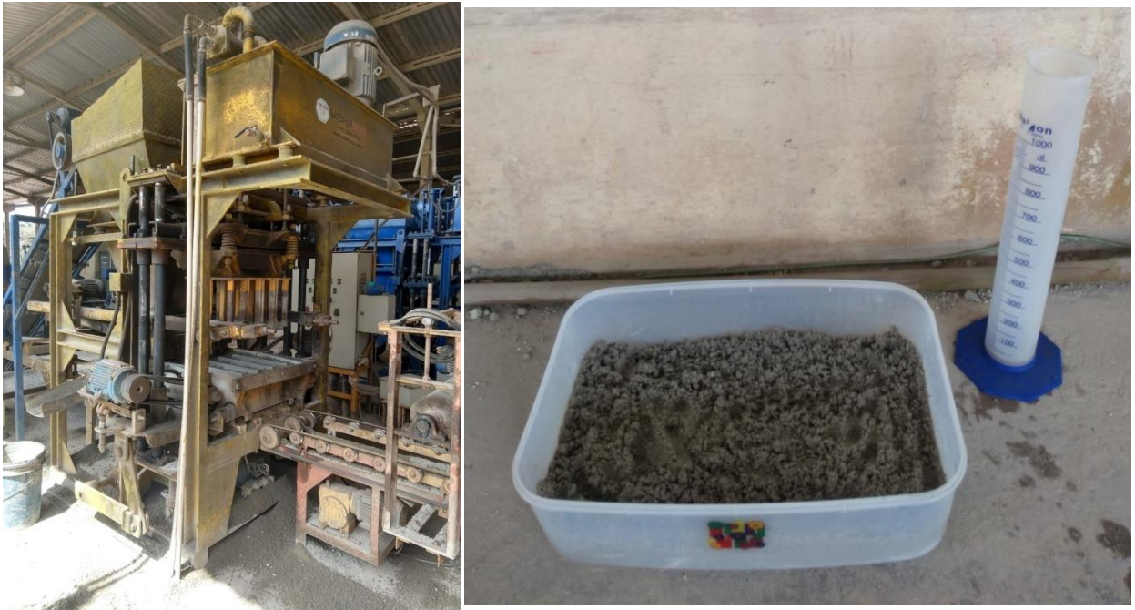
Figura 3.8 – Vibroprensa e pré-saturação do material.
