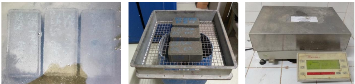
Figura 3.12 – Corpos de prova imersos em água, secagem dos CP's e balança.
