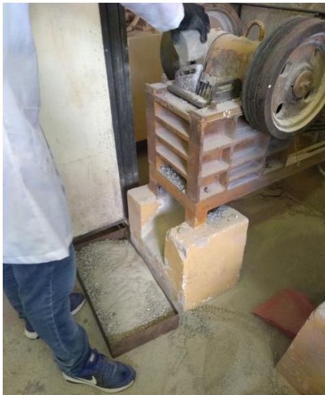
Figura 3.4 – Britador de mandíbula e material obtido.
