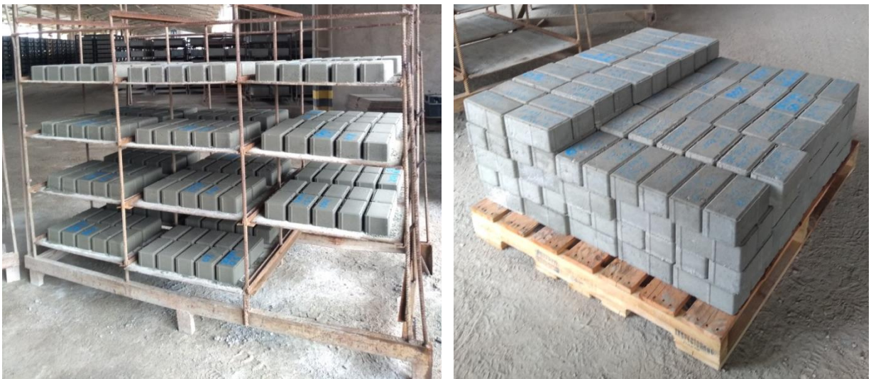
Figura 3.10 – Pavers fabricados e armazenados.
