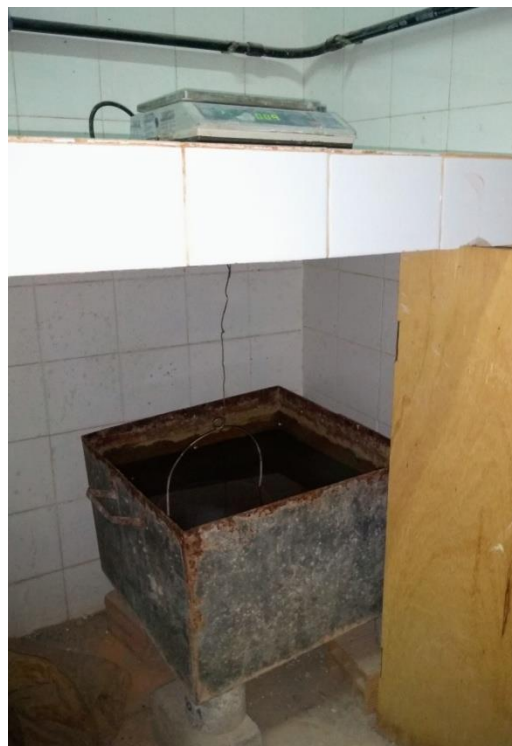
Figura 3.7 - Ensaio de absorção proposto por Leite (2001).
