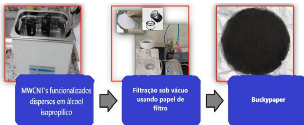
Figura 2.3 - Processo de fabricação da BP por filtração a vácuo. Fonte :Adaptado de PINHEIRO et al. (2019).
