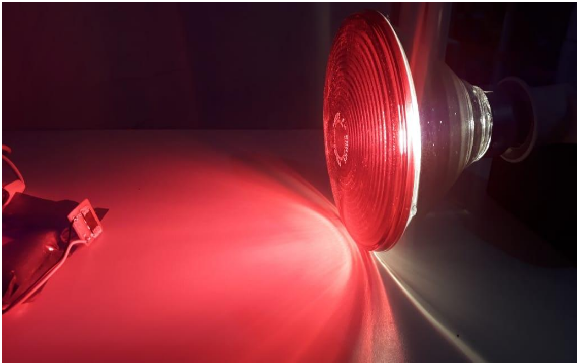
Figura 4.4 - Teste termelétrico Indoor utilizando uma lâmpada infravermelha PAR38.
