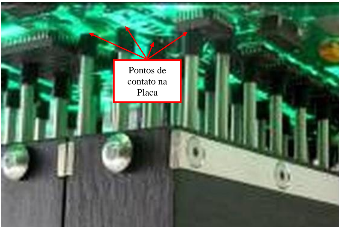
Figura 4.4 - Exemplo de suporte de PCB adaptável em uso.
