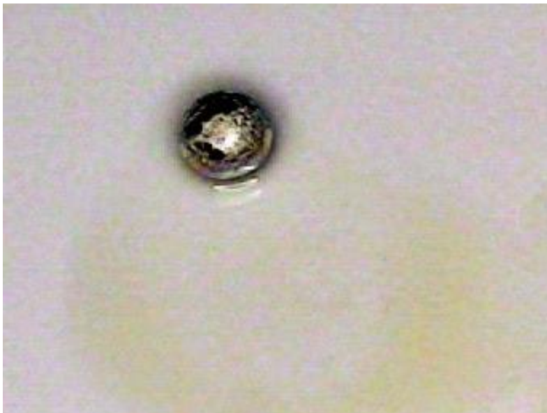
Figura 4.9 - Boa coalescência de solda.
