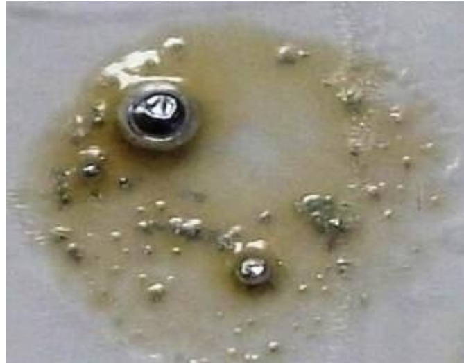
Figura 4.10 - Baixa coalescência de solda.
