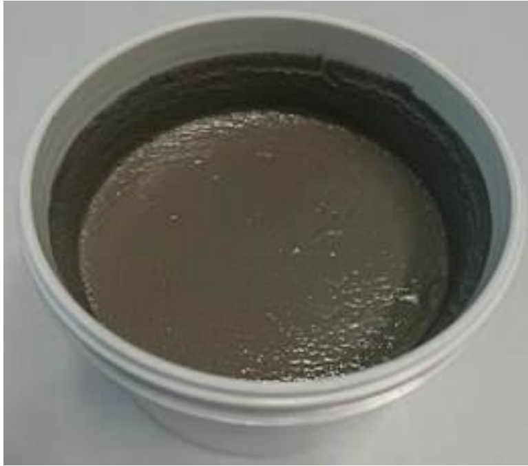
Figura 4.8 - Pasta de solda após mistura.
