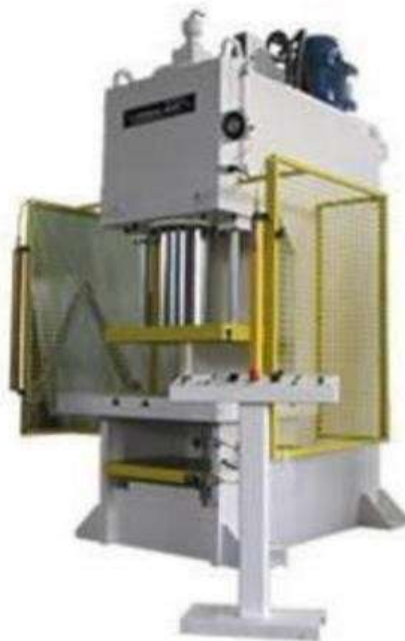
Figura 2.13 - Prensa hidráulica protegida. Fonte: SILVA (2008).
