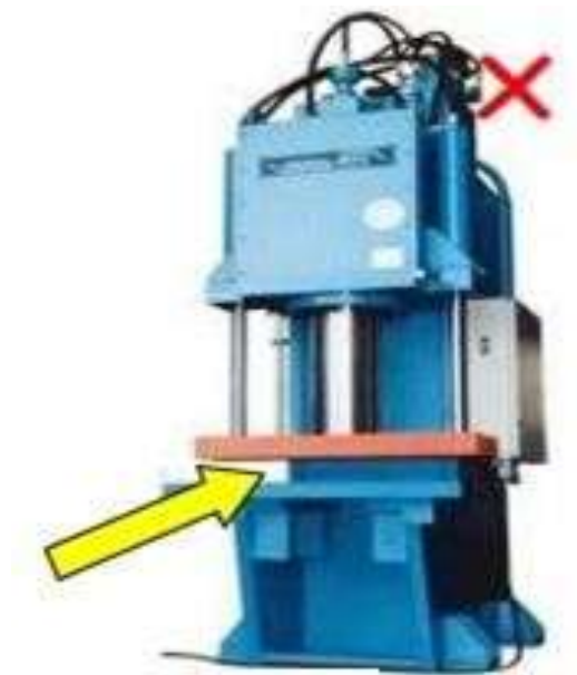
Figura 2.12 - Prensa hidráulica com zona de prensagem desprotegida. Fonte: FIERGS, Manual de Segurança em Prensas e Similares (2006).
