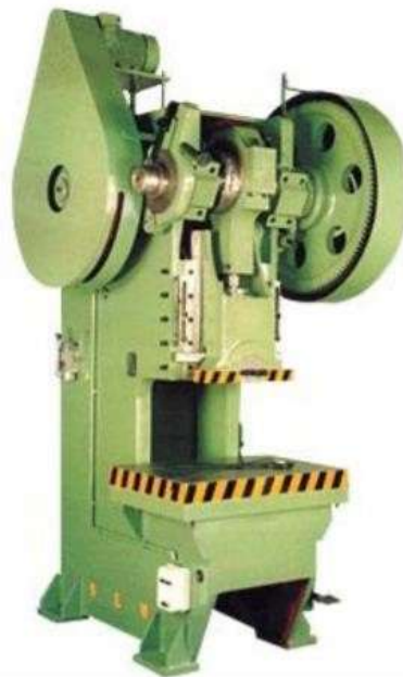
Figura 2.10 - Prensa mecânica excêntrica com freio/embreagem. Fonte: BECKER et al. (2006).
