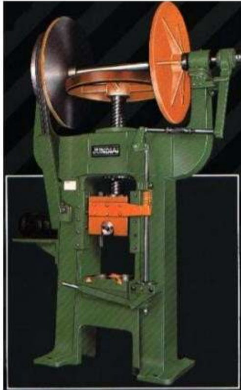
Figura 2.11 - Prensa mecânica de fricção com acionamento por fuso. Fonte: BECKER e MISTURINI (2011).
