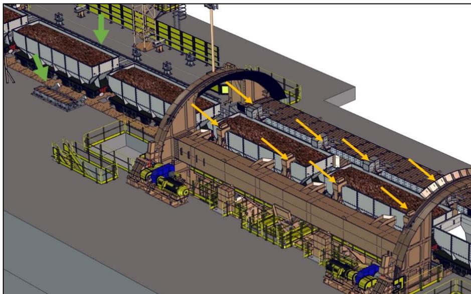
Figura 3.13 - Vista geral sistema giro e travas do vagão.
