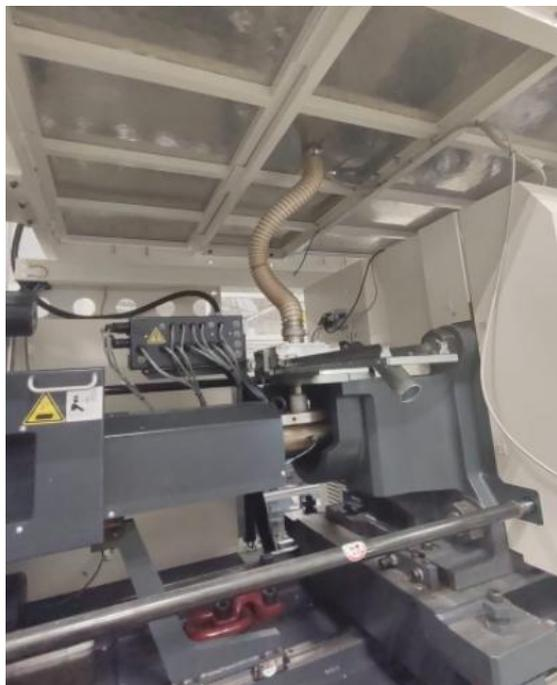
Figura 4.14 - Mangueira plástica conectando funil ao cilindro.
