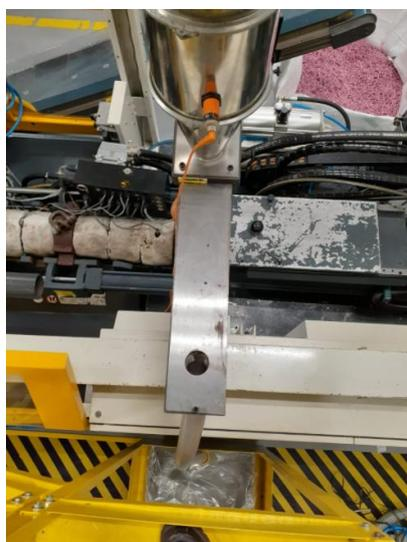
Figura 4.10 - Vista superior do suporte do funil de alimentação - Escala 1:25.
