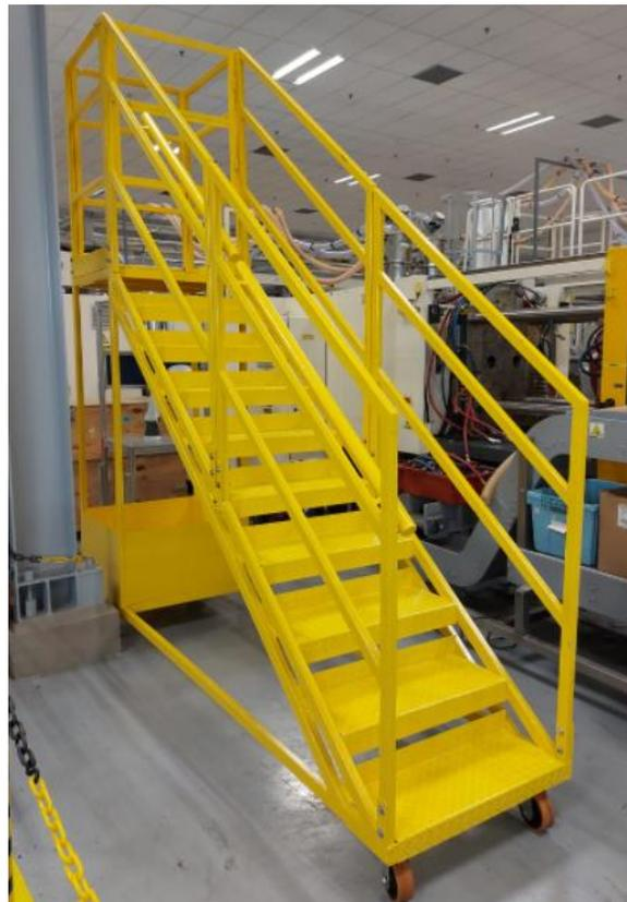
Figura 4.7 - Protótipo finalizado de escada de acesso.
