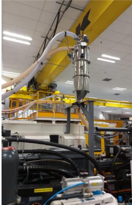
Figura 4.8 - Protótipo finalizado de suporte de funil de alimentação.
