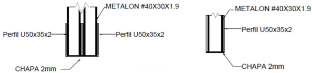
Figura A.1 - Detalhes para encaixe do guarda-corpo - Sem escala.
