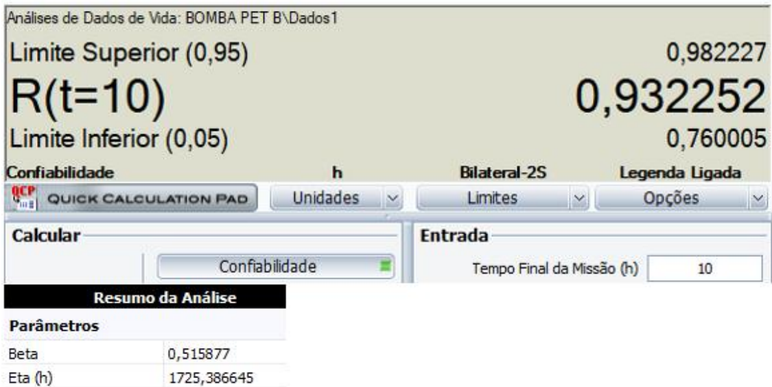
Figura 4.7 - Resultado de confiabilidade do sistema de bombeio B, calculado pelo software.
