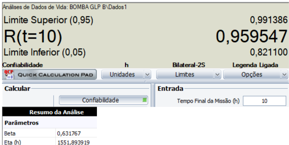
Figura 4.27 - Resultado de confiabilidade do sistema de bombeio GLP B, calculado pelo software.
