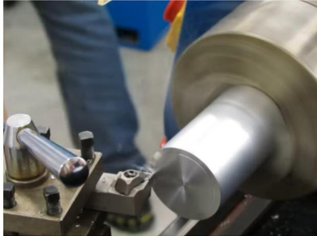
Figura 3.4 - Processo de faceamento.
