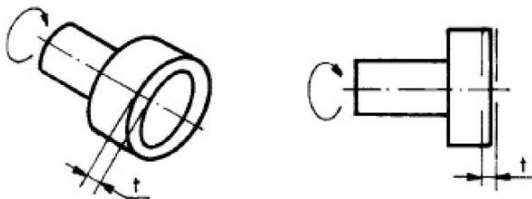
Figura 3.6 - Representação do batimento axial.
