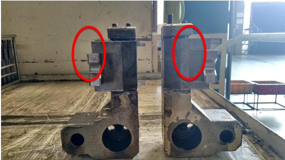
Figura 4.2 - Dispositivos de ajuste dos eixos de transmissão vista frontal.
