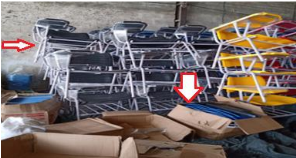
Figura 4.2 - Material acabado armazenado junto com matéria prima.
