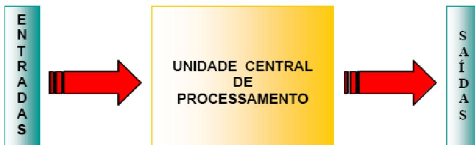
Figura 2.26 - Estrutura básica de um CLP.
