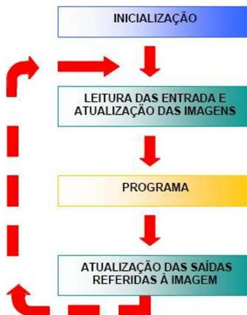
Figura 2.27 - Ciclo de processamento do CLP.
