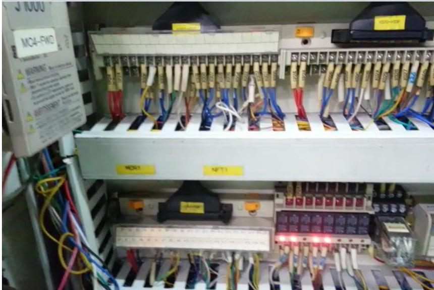
Figura 3.17 - Dispositivos de entrada usados na programação de novo sistema de injeção.
