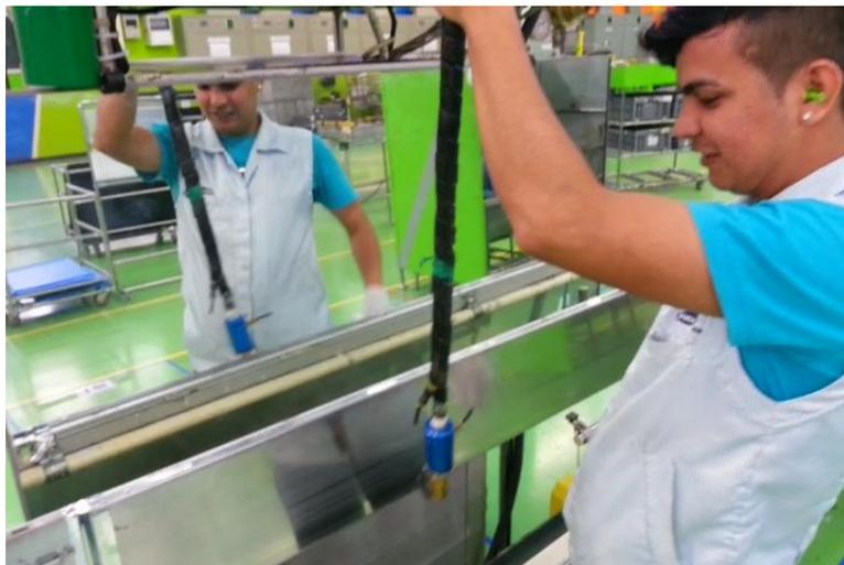
Figura 3.5 - Acoplador ligado diretamente na mangueira de alta pressão.
