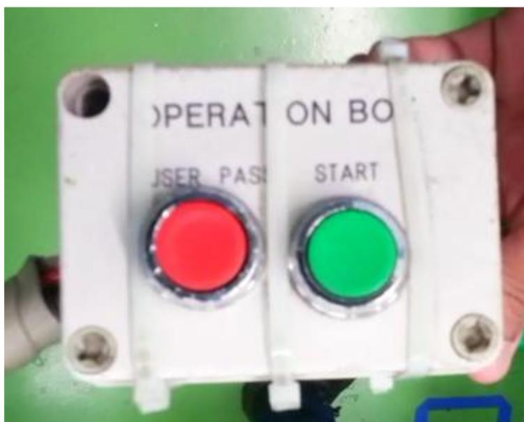
Figura 3.8 - Caixa com botões liga e desliga.
