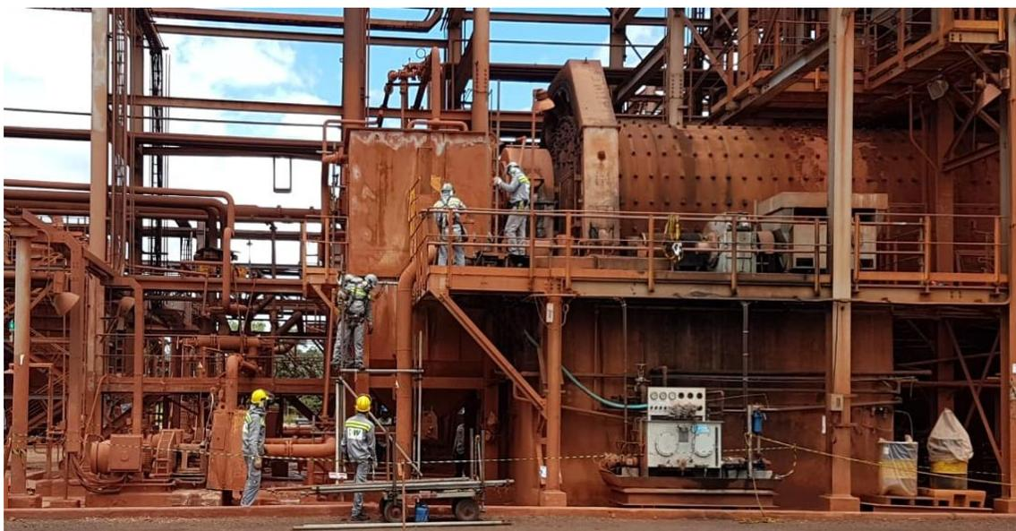
Figura 2.8 - Visão geral do circuito fechado de moagem: 2 circuitos com 2 moinhos cada.
