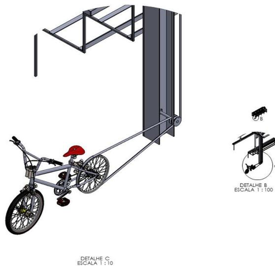
Figura 4.4 - Acoplamento da bicicleta no sistema semiautomatizado em escala 1:100.
