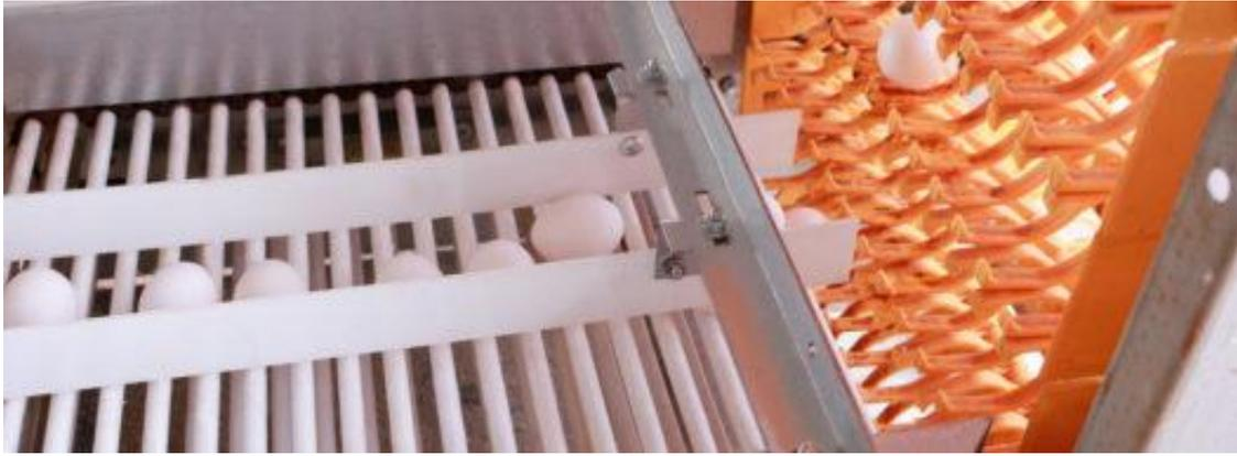
Figura 2.5 - Esteira transportadora automatizada de ovos e recolhedor de ovos.
