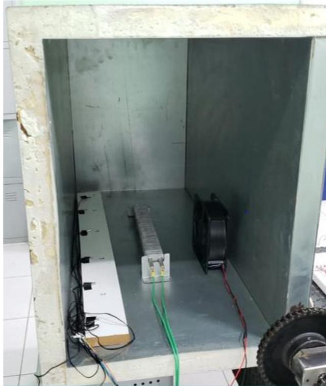
Figura 4.19 - Instalação de elementos no isolamento térmico.
