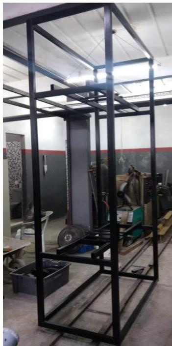
Figura 4.22 - Estrutura do elevador vertical.
