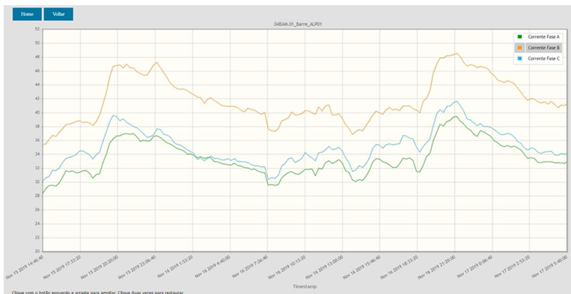
Figura 4.3 - Gráfico de correção da corrente elétrica do alimentador 01.
