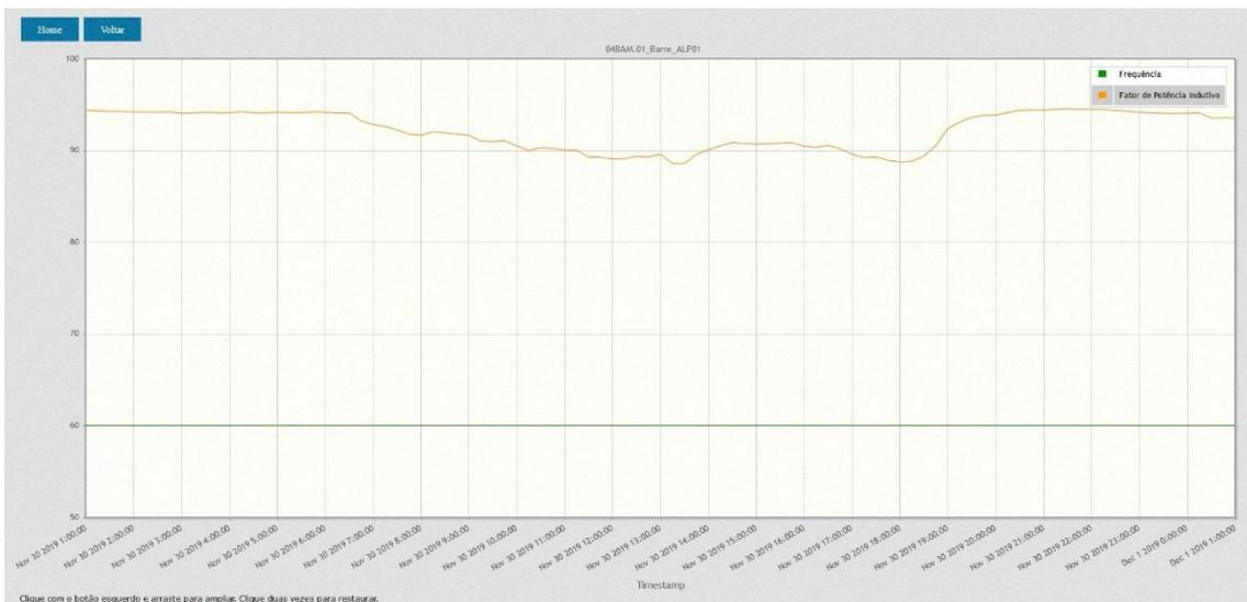
Figura 3.26 - Gráfico de medições de fator de potência/frequência.
