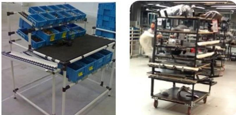
Figura 4.10 - Sistema de alimentação de miúdo à esquerda e carro com *kit* à direita.
