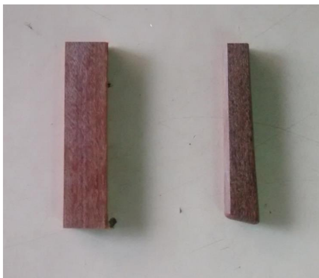
Figura 4.5 - Amostra de um tipo de cabo com seu respectivo taco, produzido nas máquinas do roteiro 3.
