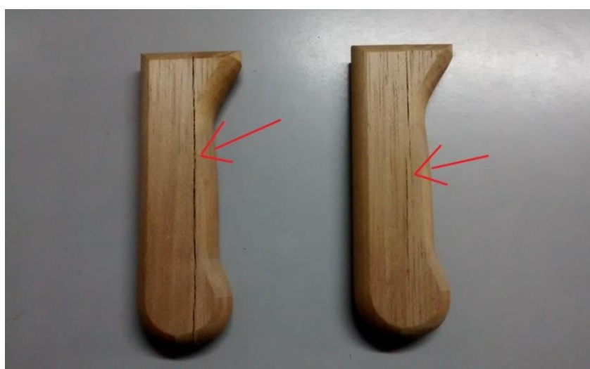
Figura 4.15 - Cabos inutilizados por conta de trincas no processo.
