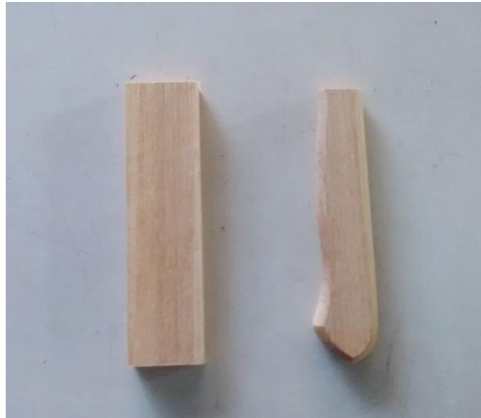
Figura 4.3 - Amostra de um tipo de cabo com seu respectivo taco, produzido nas máquinas do roteiro 1.
