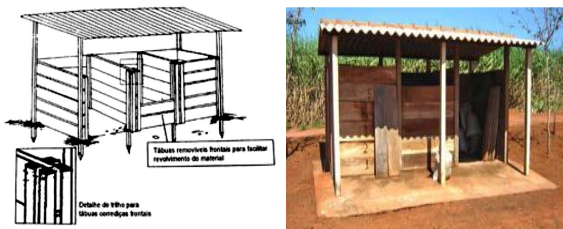
Figura 4.28 - Composteira em sistema de tábuas corrediças para a reciclagem de resíduos orgânicos. A) Desenho da estrutura sugerida para compostagem de resíduos orgânicos. B) Exemplo de uma composteira de resíduos orgânicos em sistemas de tábuas corrediças.
