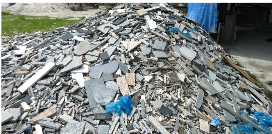
Figura 3.2 - Resíduos de corte de placas de mármore e granito.
