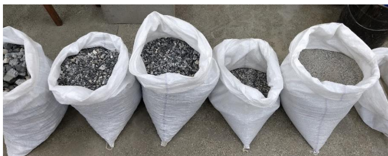
Figura 3.7 - Agregados separados conforme a granulometria.
