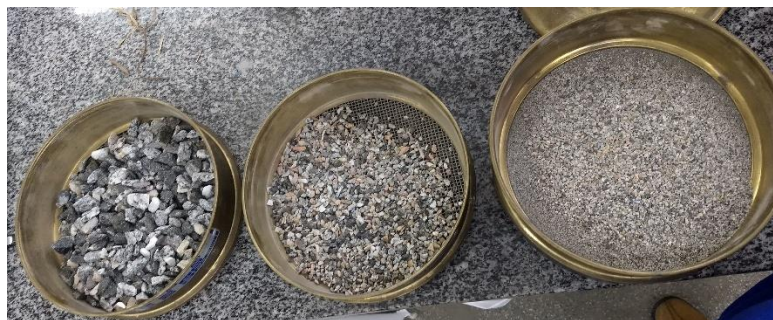
Figura 3.6 - Retenção de agregados.
