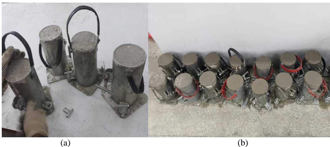
Figura 3.10 – Moldagem dos corpos-de-prova: (a) Corpos-de-prova enformados; (b) Corpos-de-prova em cura inicial de 24 horas.
