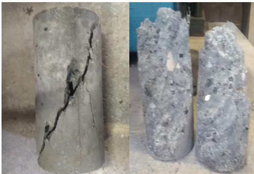
Figura 3.12 - Apresentação de um corpo-de-prova após o rompimento.
