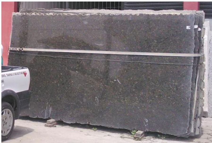
Figura 2.4 - Chapas com bordas irregulares. Fonte: RODRIGUES (2015).
