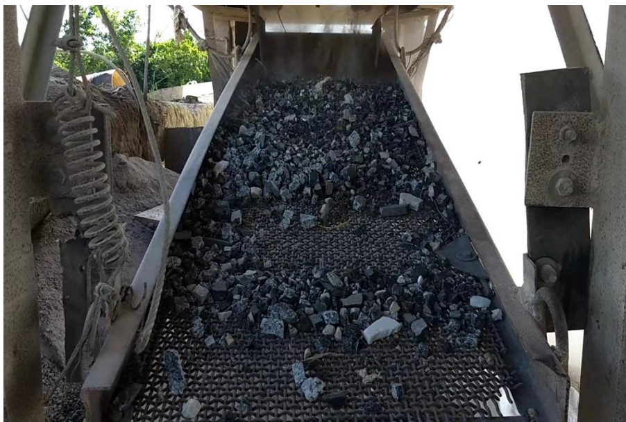
Figura 3.4 - Resíduos de corte de placas de mármore e granito triturados.
