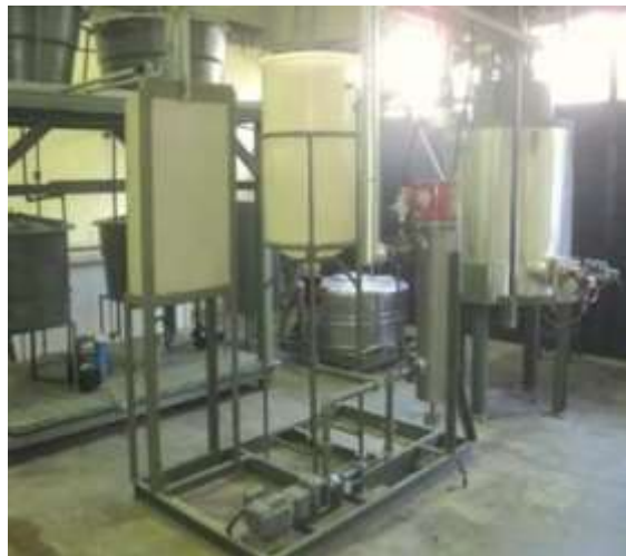
Figura 9 – Sistema de alimentação/Tanque.
