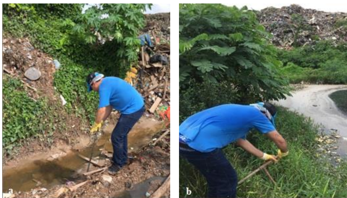
Figura 3.4 - Coleta de solo na base da célula (a) e lagoa de deposição de chorume (b).
