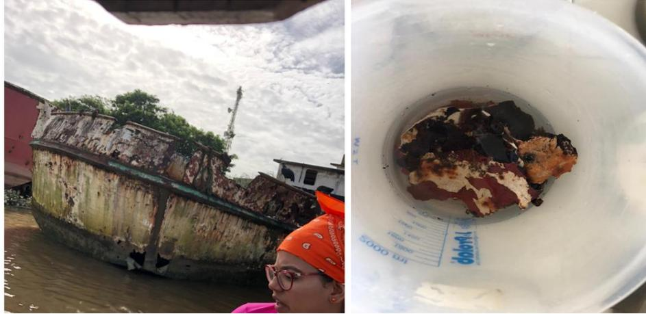
Figura 4- À esquerda, embarcação do estaleiro ABS de onde foi obtido as amostras de fragmentos do casco D. À direita, a mesma amostra sendo lavada com água deionizada.
