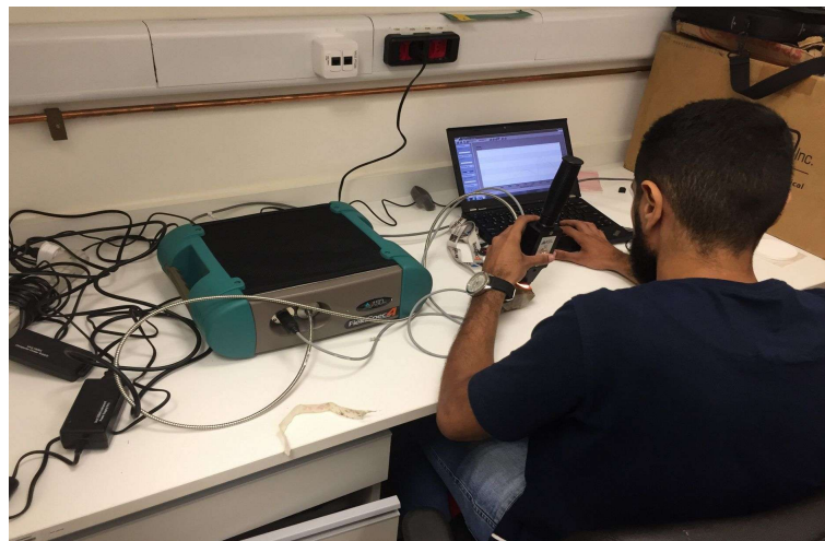
Figura 5 - Espectroradiômetro ASD FieldSpec 4 Hi-Res e PC IBM portátil acoplado, utilizados para aquisição de dados no Laboratório do ITVale (Belém).
