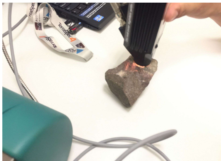
Figura 6 - Sonda de contato com iluminação embutida do espectraloradiômetro utilizada sobre a amostra.
