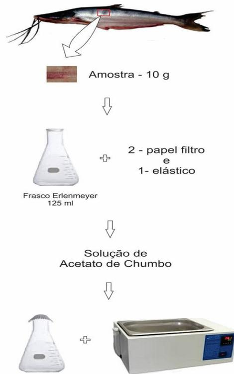
Figura 3.5 - Esquema da metodologia utilizada para o teste de determinação do H<sub>2</sub>S presente no músculo do mapará.
